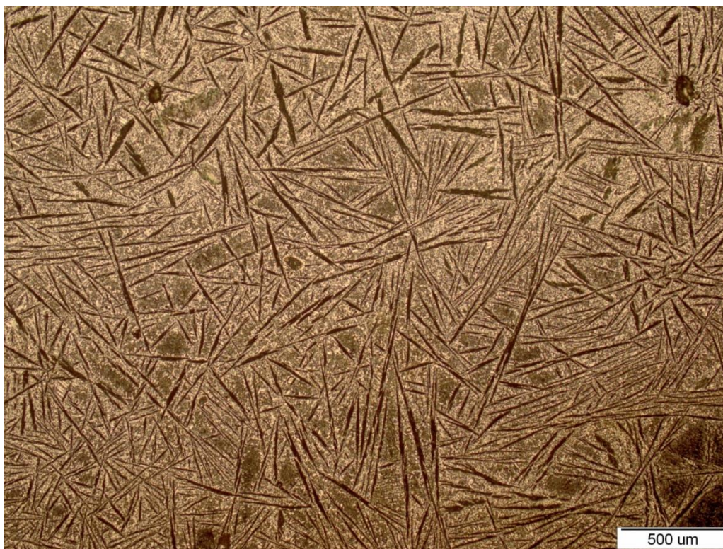
Slika 31. Mikrostruktura tvrdog navarenog sloja uzorka H3-3
