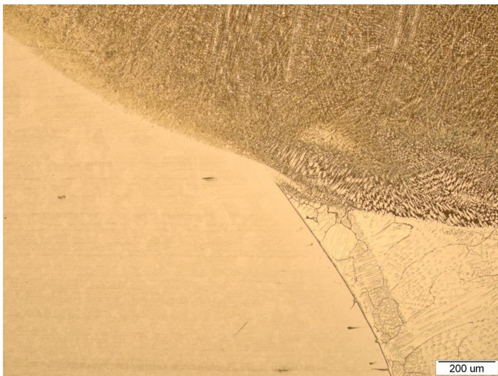
Slika 35. Mikrostruktura u području zone staljivanja uzorka T4-2
