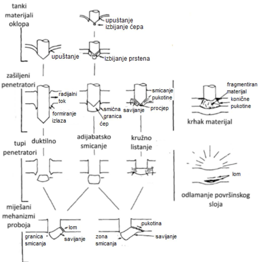
Slika 17. Mehanizmi proboga oklopa [3]
