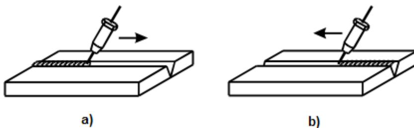
Slika 14. Tehnike zavarivanja - desna a) i lijeva b) tehnika rada [15]
