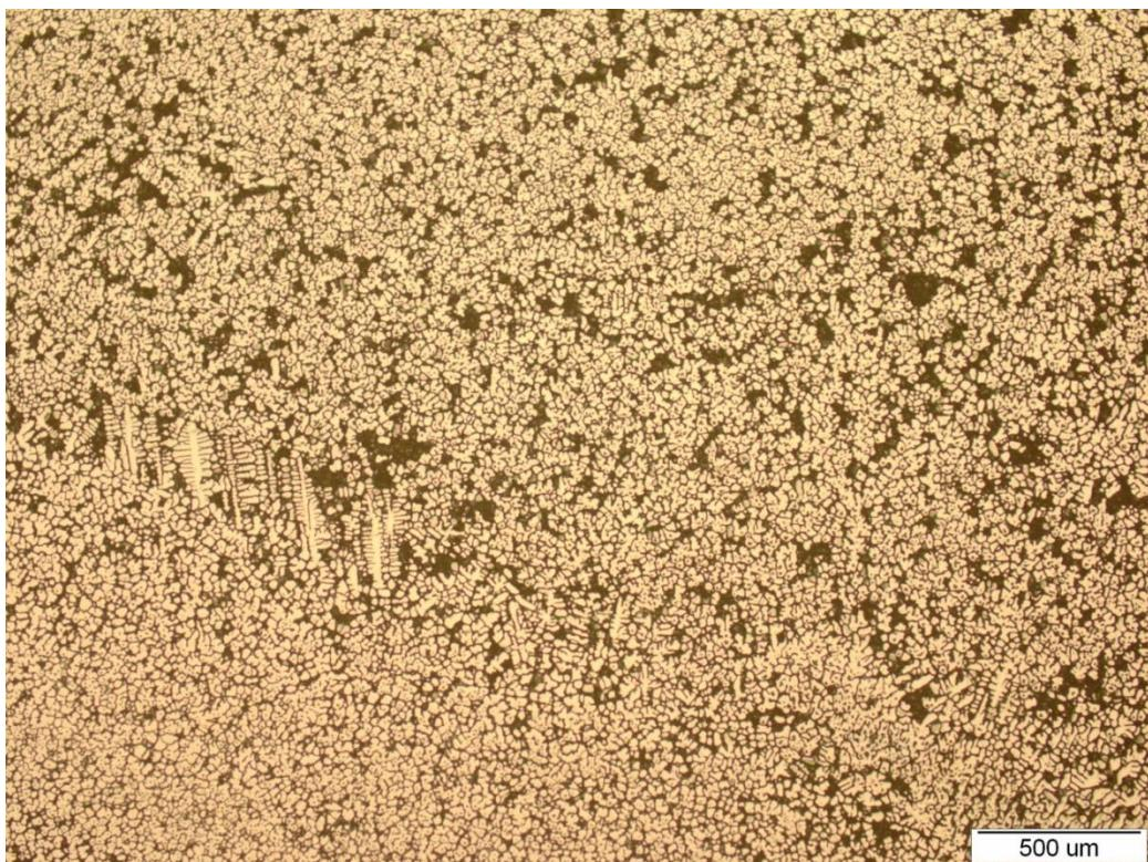
Slika 32. Mikrostruktura vrha zavarenog spoja uzorka H3-3
