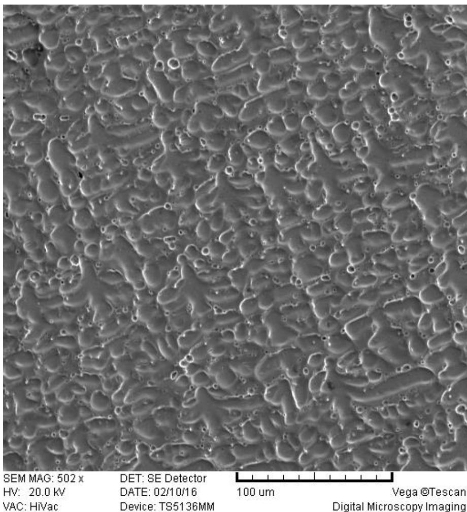
Slika 25. Mikrostruktura korijena zavarenog spoja uzorka T2-1
