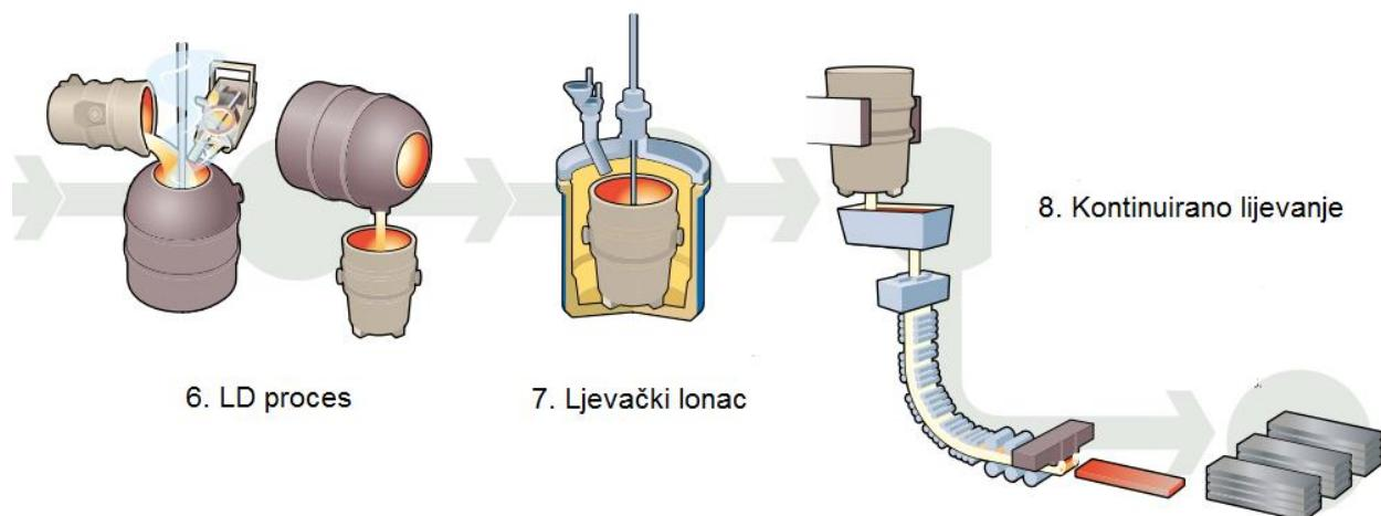
Slika 4. LD proces, Ljevački lonac i kontinuirano lijevanje [2]
