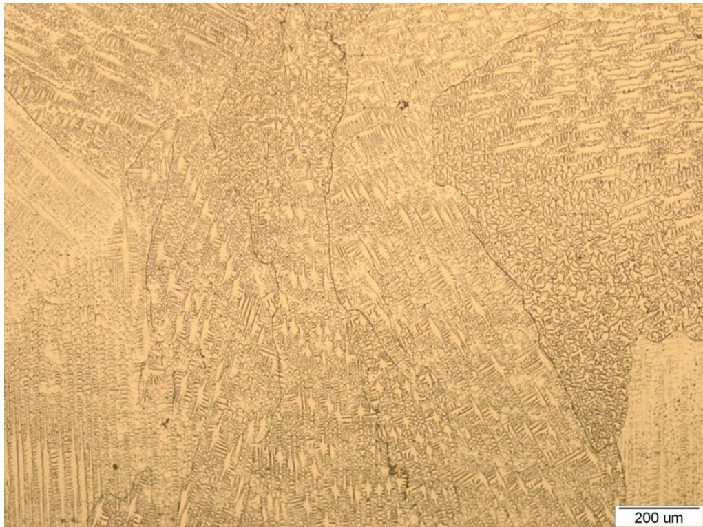
Slika 34. Mikrostruktura korijena zavarenog spoja uzorka T4-2
