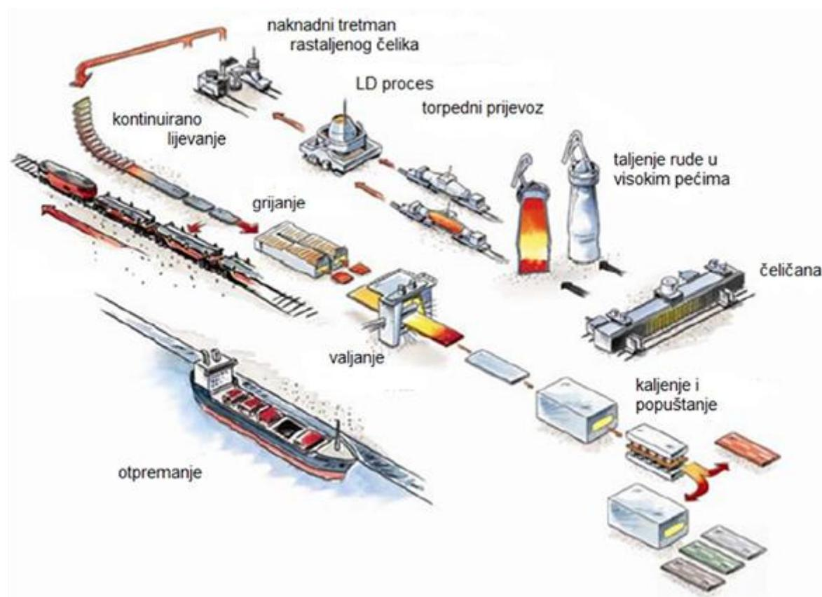
Slika 1. Tijek proizvodnje oklopnih čelika visoke tvrdoće [2]
