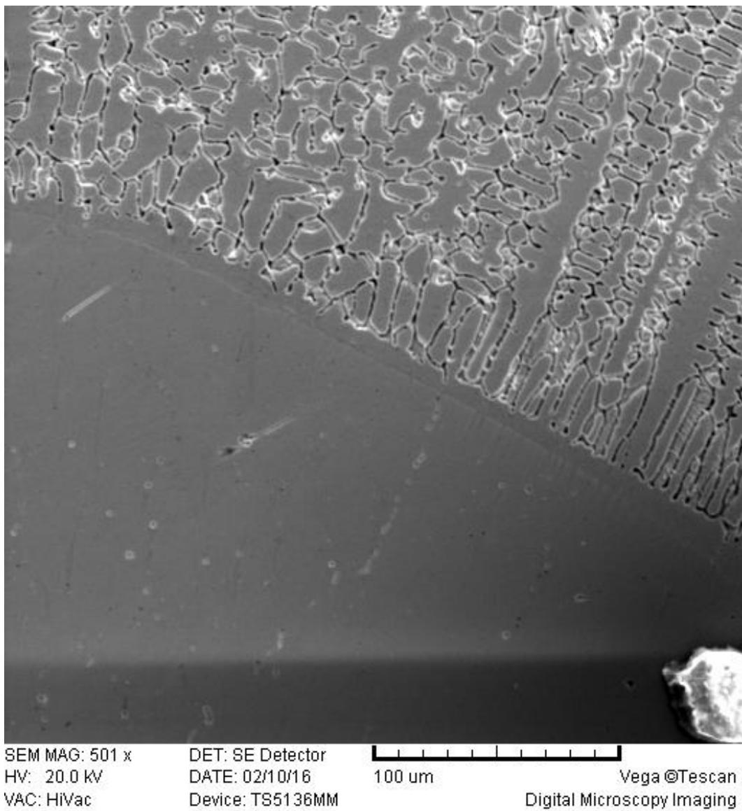
Slika 30. Mikrostruktura u području linije staljivanja uzorka H3-3
