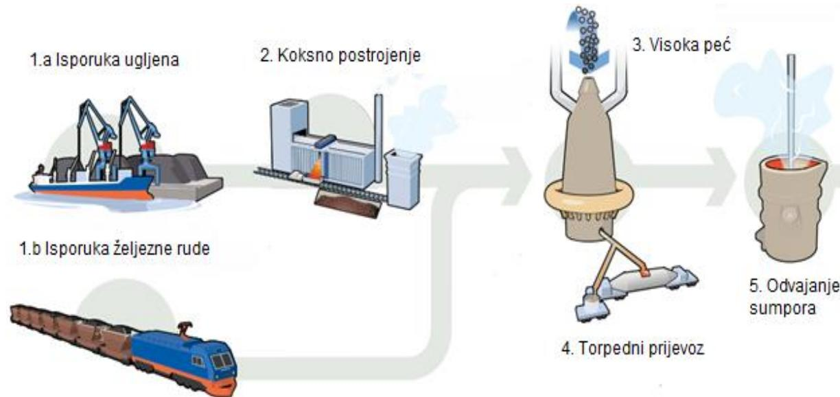
Slika 2. Isporuka sirovina, pretvorba ugljena i metalurški proces [2]
