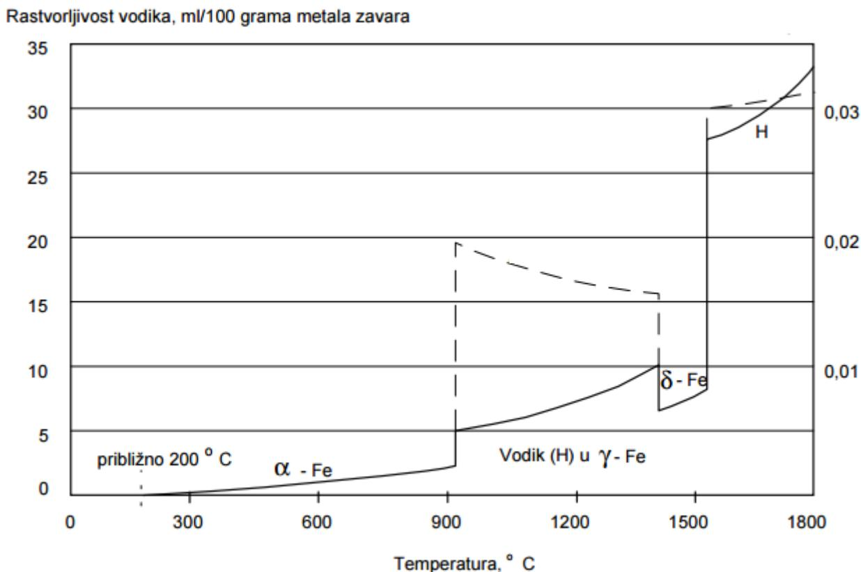
Slika 12. Rastvorljivost vodika u čistom željezu [15]
