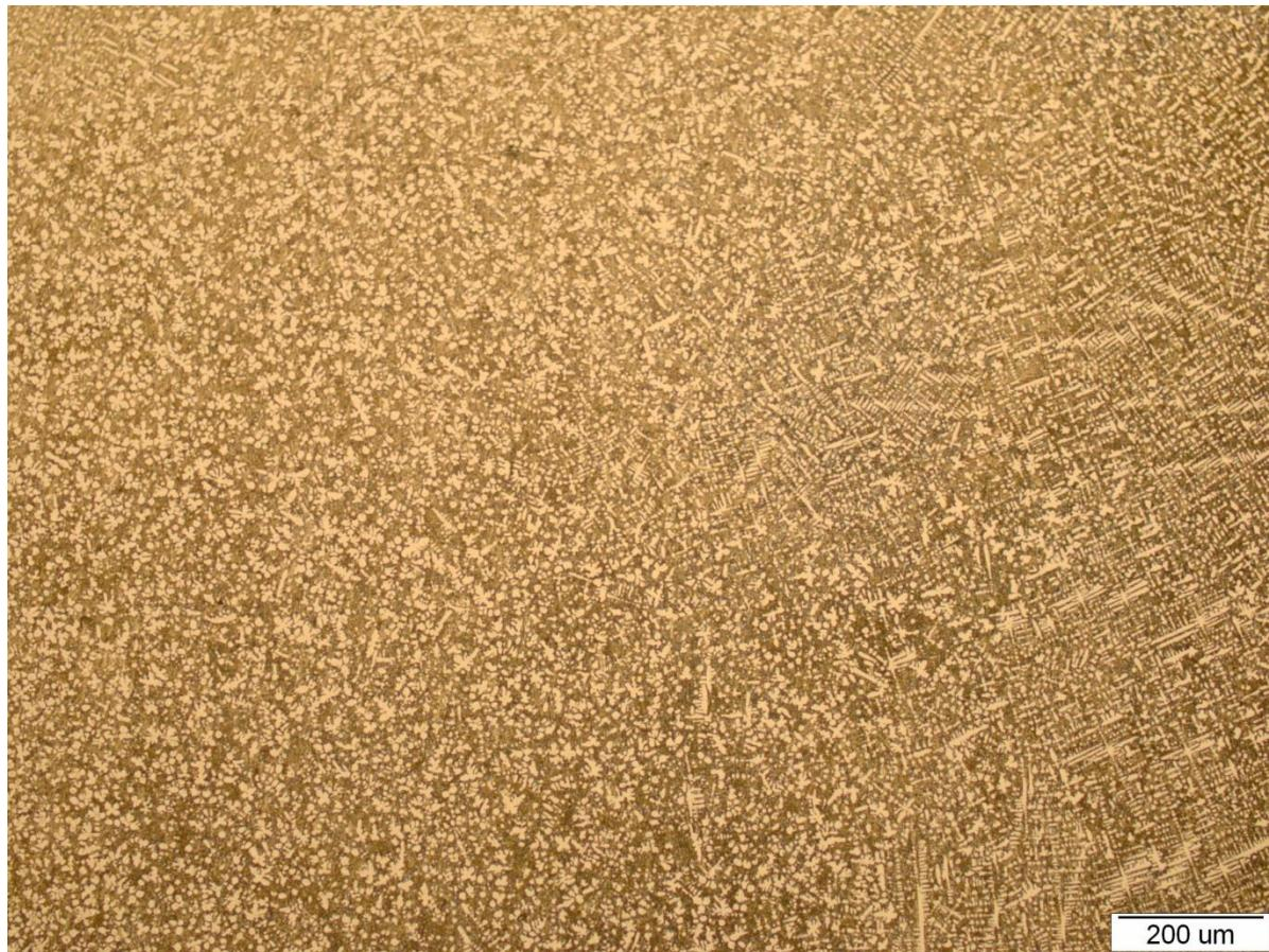
Slika 36. Mikrostruktura vrha zavarenog spoja uzorka T4-2
