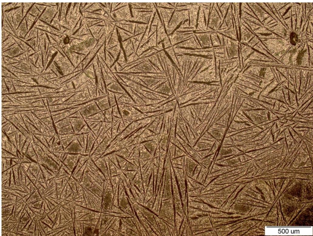
Slika 31. Mikrostruktura tvrdog navarenog sloja uzorka H3-3
