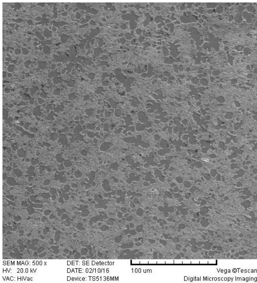
Slika 27. Mikrostruktura vrha zavarenog spoja uzorka T2-1
