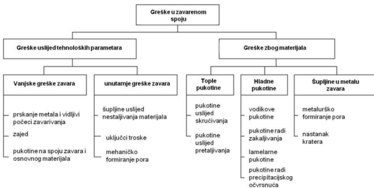
Slika 10. Vrste grešaka u zavarenom spoju [11]
