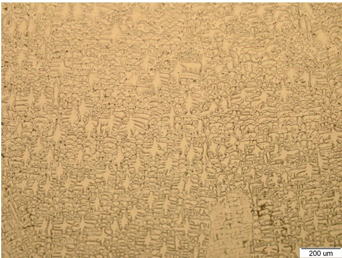
Slika 29. Mikrostruktura korijena zavarenog spoja uzorka H3-3
