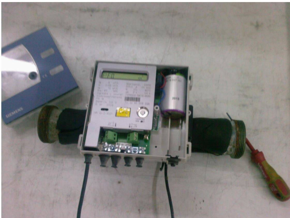
Slika 25. Primjer ispitivanja računске jedinice
