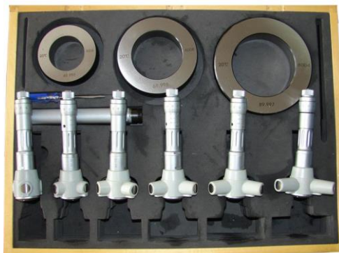
Slika 12. Set trokrakih mikrometara sa pripadajućim komponentama
