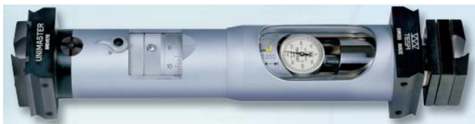
Slika 38. Unimaster proizvođača Tesa
