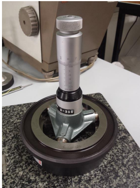
Slika 50. Trokraki mikrometar s kontrolnim prstenom promjera \varnothing 100 mm na granitnoj ploči
