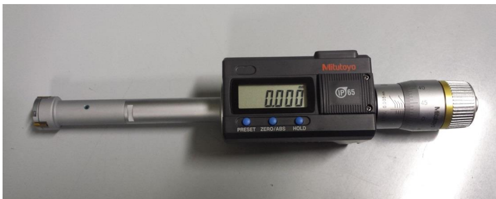
Slika 46. Digitalni trokraki mikrometar tvrtke Mitutoyo
