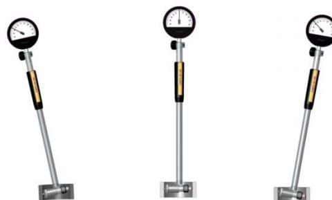
Slika 25. Određivanje ispravnog kontrolnog položaja
