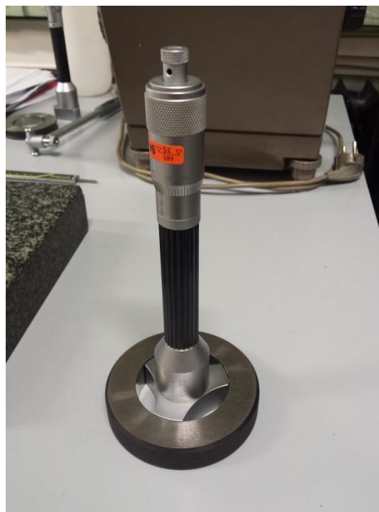
Slika 49. Kontrolni prsten promjera \varnothing 60 mm s trokrakim mikrometrom
