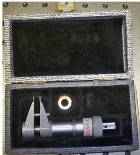
Slika 40. Mikrometar za male provrte
