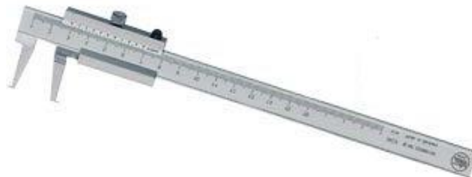
Slika 2. Pomično mjerilo za mjerenje unutarnjih promjera
