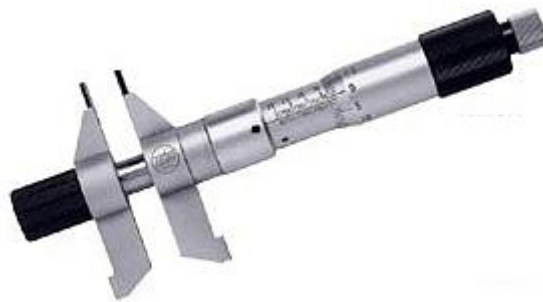
Slika 7. Mikrometar sa dvostranim čeljustima
