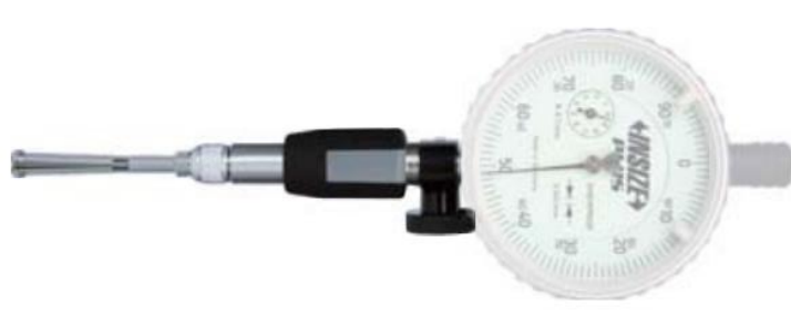
Slika 37. Mjerilo za male promjere s iglom
