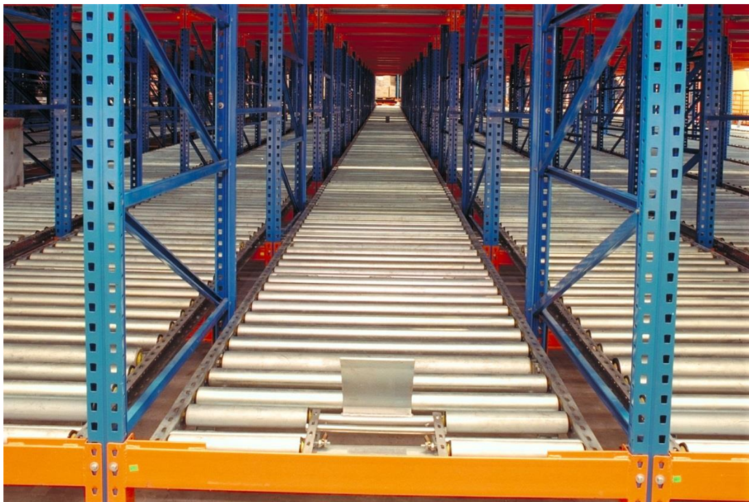
Slika 9. Protočni regali (eng. Pallet Flow Rack ) [10]
