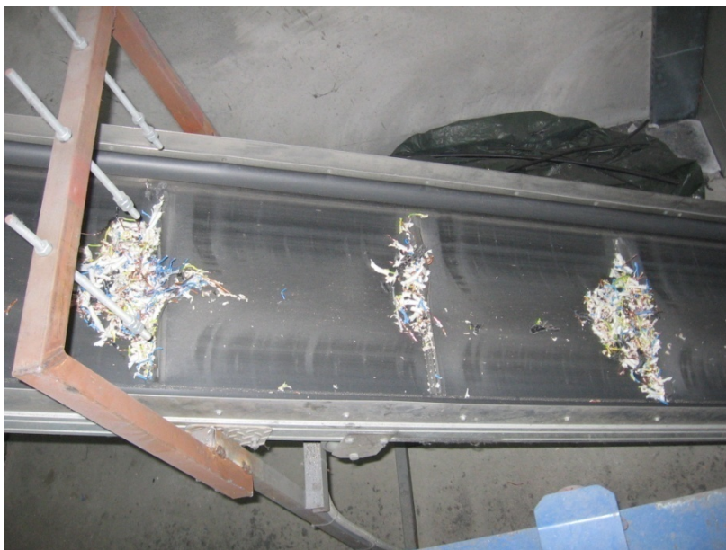
Slika 3: Usitnjeni kabel koji ulazi u mlin
