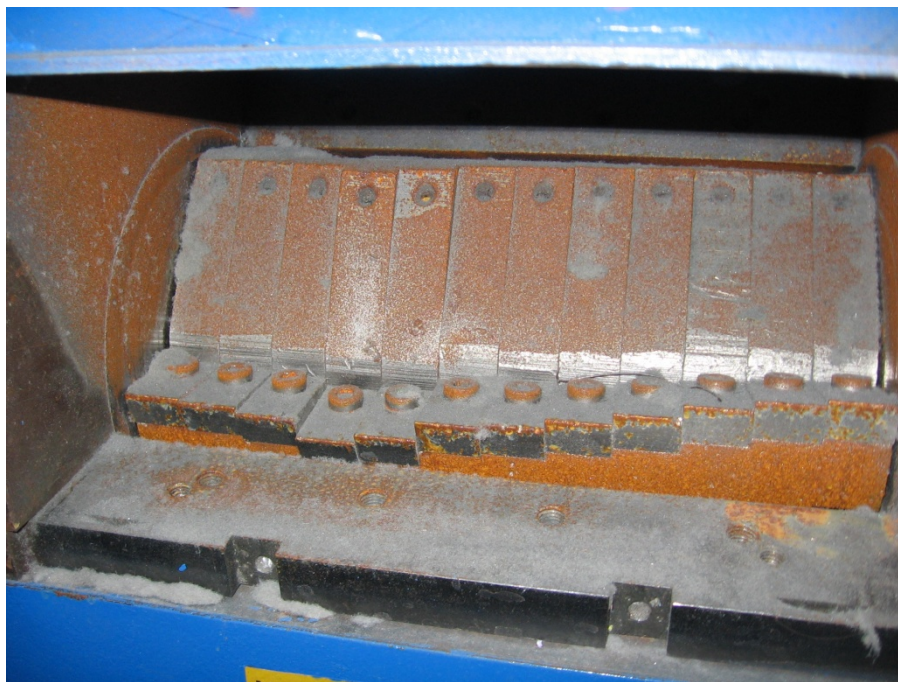
Slika 8: Mlin tip: Gladijator sa 12 držača noževa i noževima
