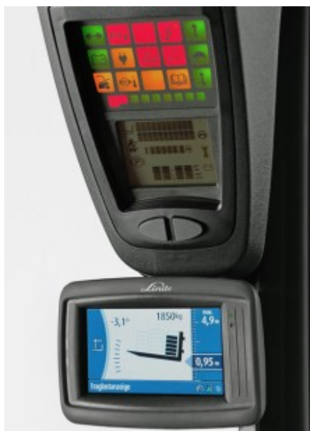
Slika 32. Prikaz Linde Safety Pilot sustava [44]
