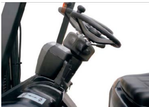
Slika 27. Podesivi volan po visini i nagibu[51]
