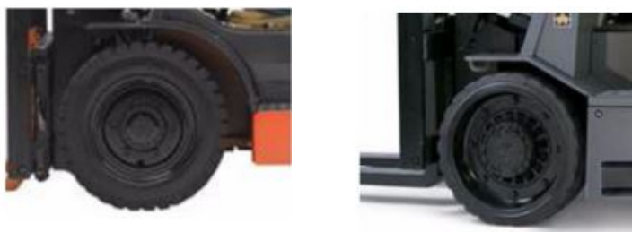
Slika 16. Prikaz punih pneumatika sa zrakom (lijevo) i "cushion" kotača (desno) [54]
