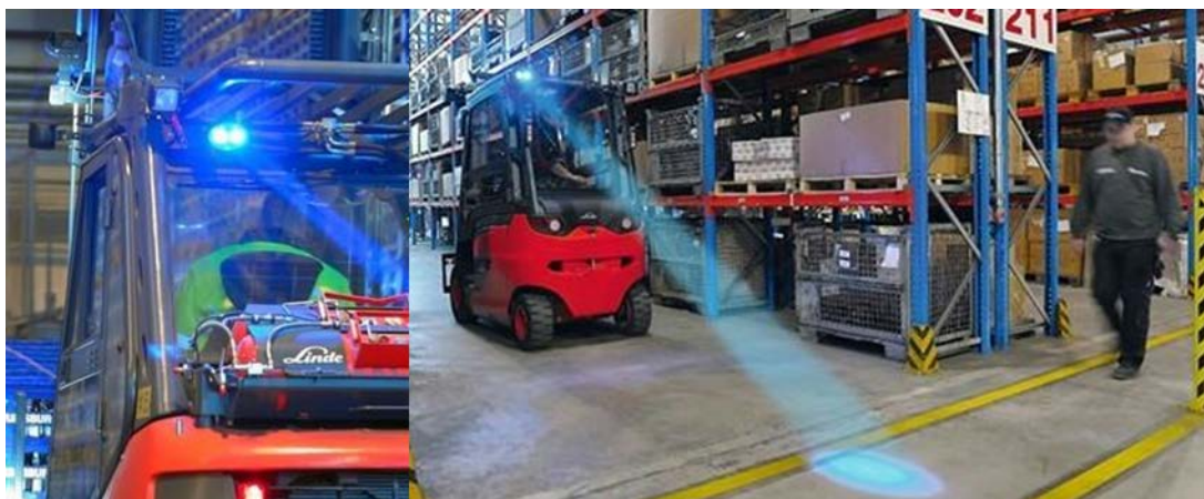
Slika 30. Prikaz rada Linde BlueSpot™ sustava[42]
