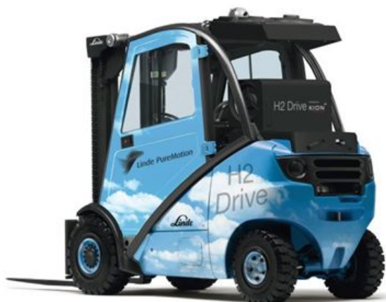
Slika 15. Viličar s gorivim ćelijama [18]
