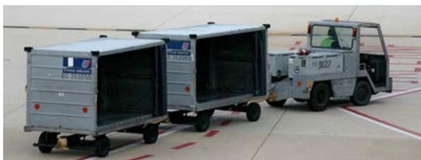
**Slika 13. Vučno motorno vozilo [16]**
