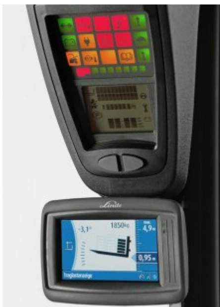
Slika 32. Prikaz Linde Safety Pilot sustava [44]
