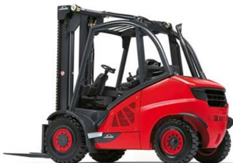
Slika 21. Viličar klase V s diesel pogonom [24]
