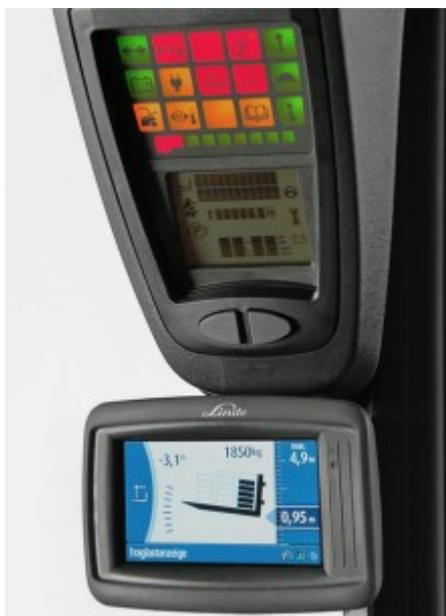
**Slika 32. Prikaz Linde Safety Pilot sustava [44]**
