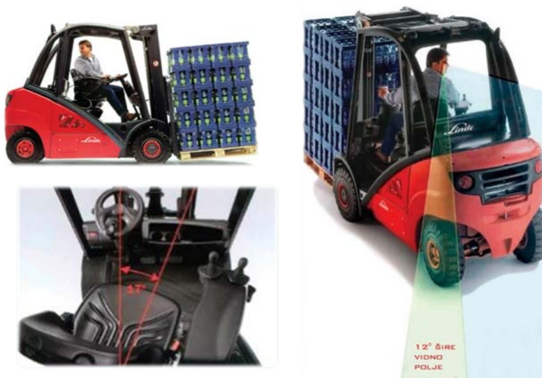
Slika 25. Viličar sa zakretanjem konzole za 17°[33]
