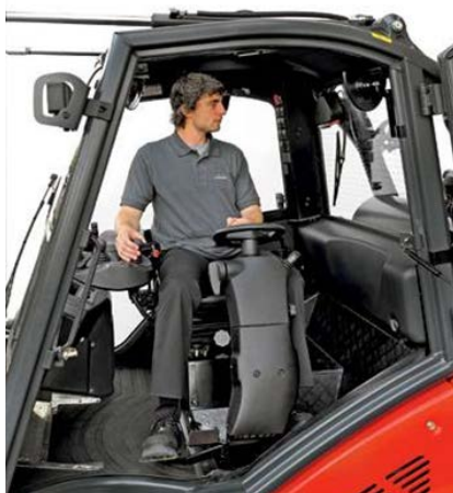
Slika 26. Viličar s mogućnosti zakretanja sjedala i konzole s volanom i upravljačkom komandom za 90°[34]
