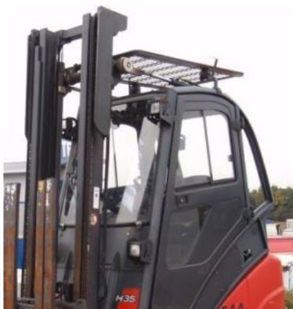
Slika 28. Rešetka na krovu viličara[35]
