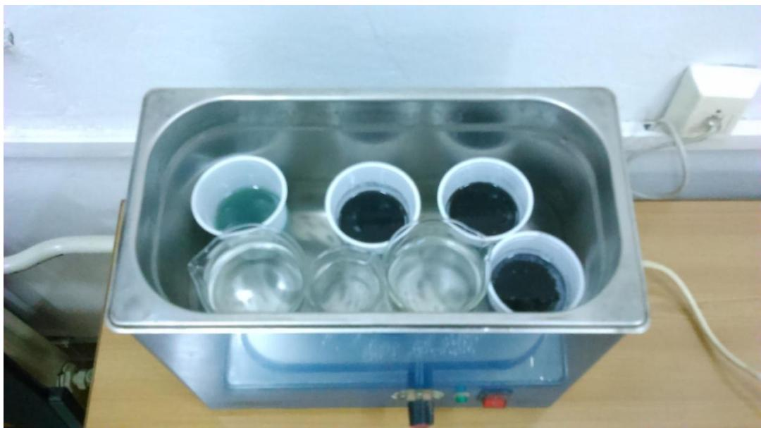
**Slika 14. Otopine poliestera s različitim udjelima ugljičnih nanocjevčica u uređaju za ultrazvuk ISKRA UZ 4F**
