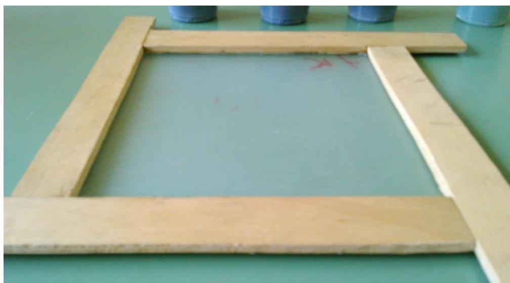
**Slika 16. Kalup premazan slojem paste za odljepljivanje**
