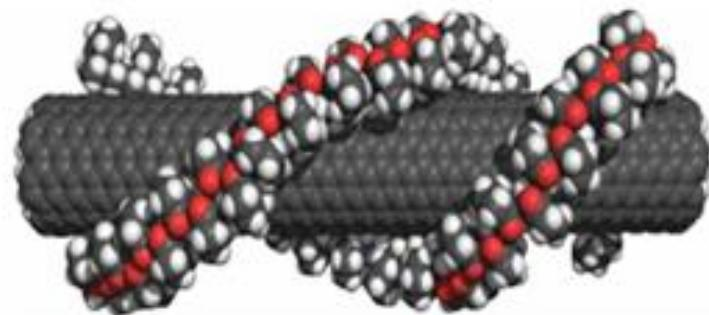
**Slika 13. Omotavanje površine SWNT nekovalentnim polimernim omotom [4]**
