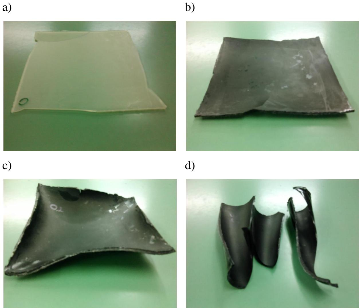
**Slika 18. Uzorci nakon vađenja iz kalupa:a) 0-ti uzorak (čisti polimer), b) uzorak s 0,1% udjela nanopunila, c) uzorak s 0,2% nanopunila, d) uzorak s 0,5% nanopunila**
