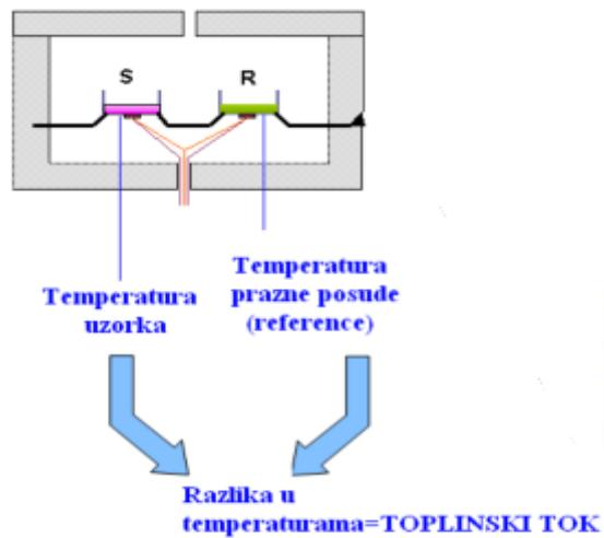
**Slika 20. Princip mjerena razlike u temperaturama DSC uredajem [13]**
