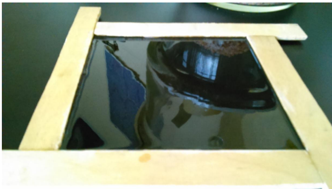
Slika 17. Uzorak s 0,1 % udjela nanopunila u procesu polimerizacije
