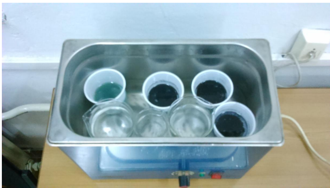
Slika 14. Otopine poliestera s različitim udjelima ugljičnih nanocjevčica u uređaju za ultrazvuk ISKRA UZ 4F
