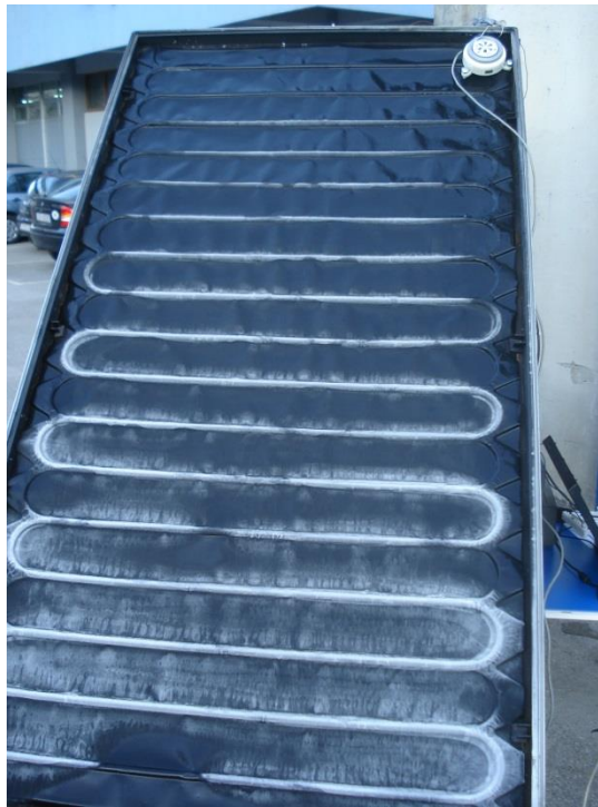
Slika 18 Zaleđena apsorberska površina
