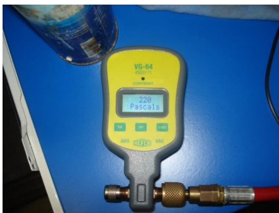
Slika 10 Apsolutni tlak nakon vakumiranja
