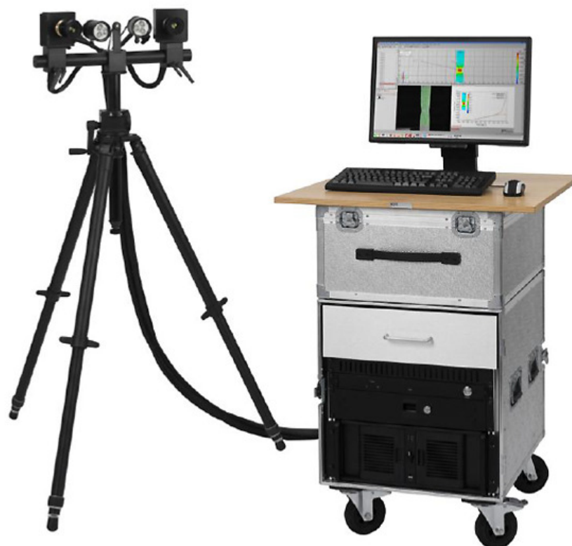
Slika 25 Sustav za optičko mjerenje, Aramis 4M
