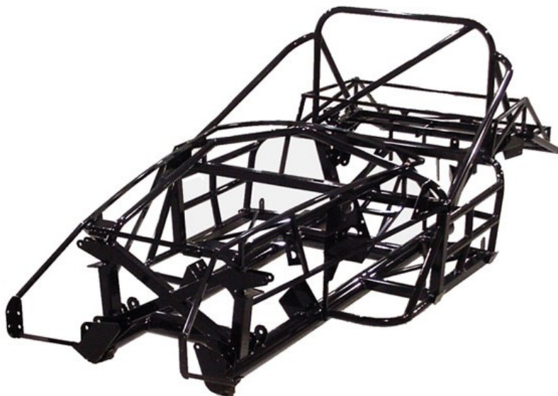
Slika 1.4 Okvir otvorenog sportskog automobila tipa GT-1 [6]
