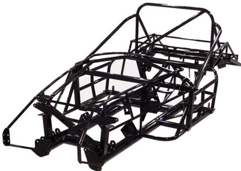
Slika 1.4 Okvir otvorenog sportskog automobila tipa GT-1 [6]
