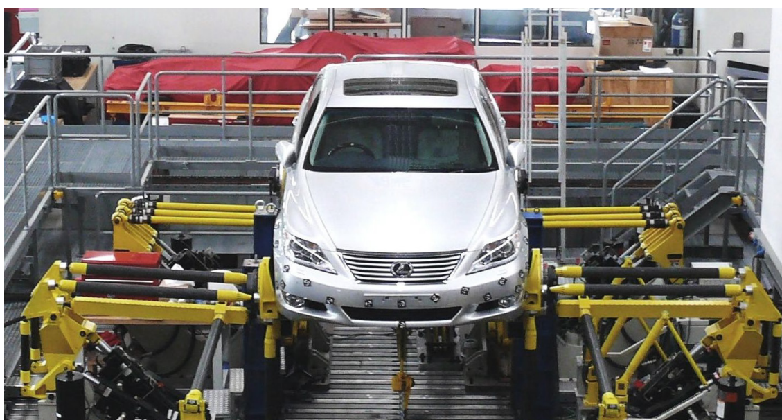
Slika 1.12 Testiranje torzijske krutosti gotovog automobila u industrijskim uvjetima [11]
