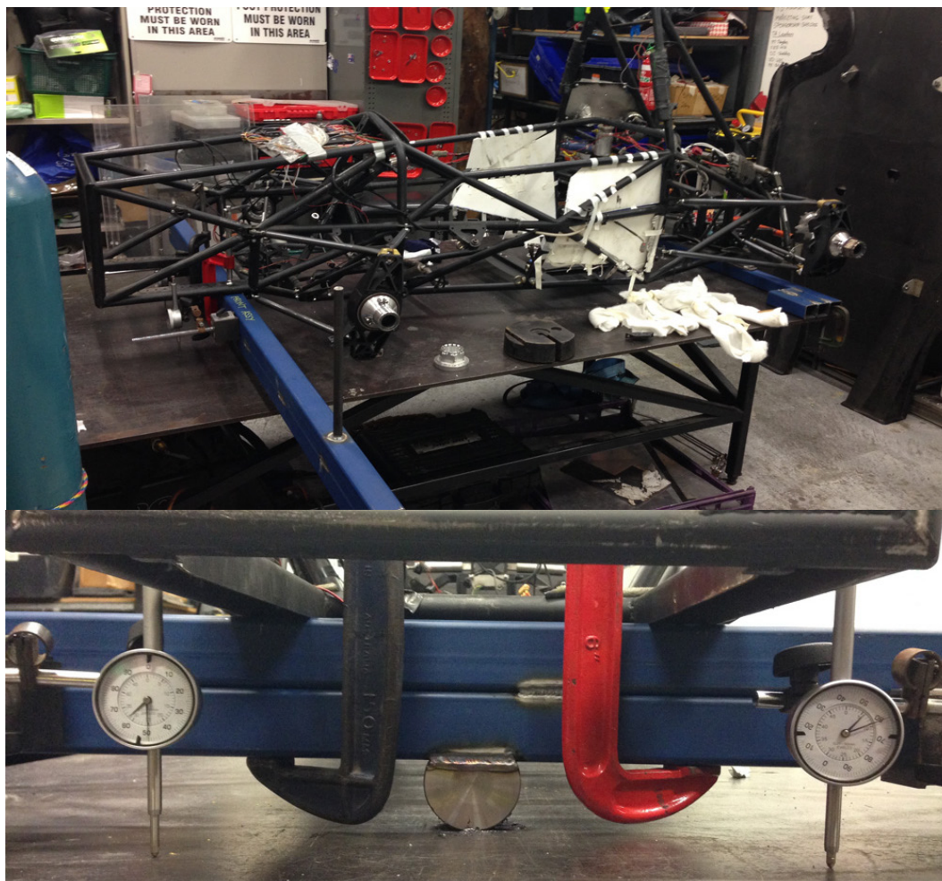
Slika 1.11 Testiranje torzijske krutosti na izrađenom okviru bolida Curtin Motosport tima[10]
