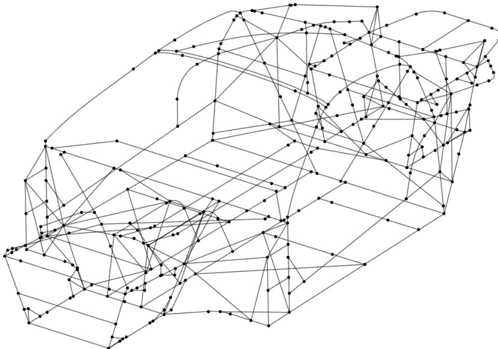
Slika 4.3 Proračunski model okvira izveden linijama u programskom paketu CATIA
