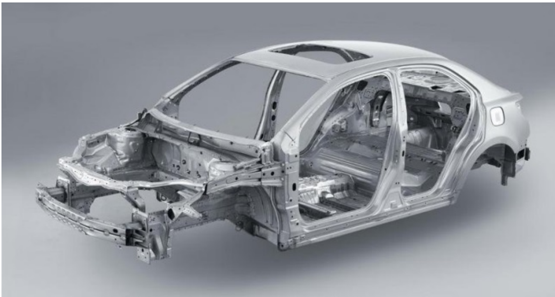
Slika 1.6 Izrađena samonosiva karoserija [7]
