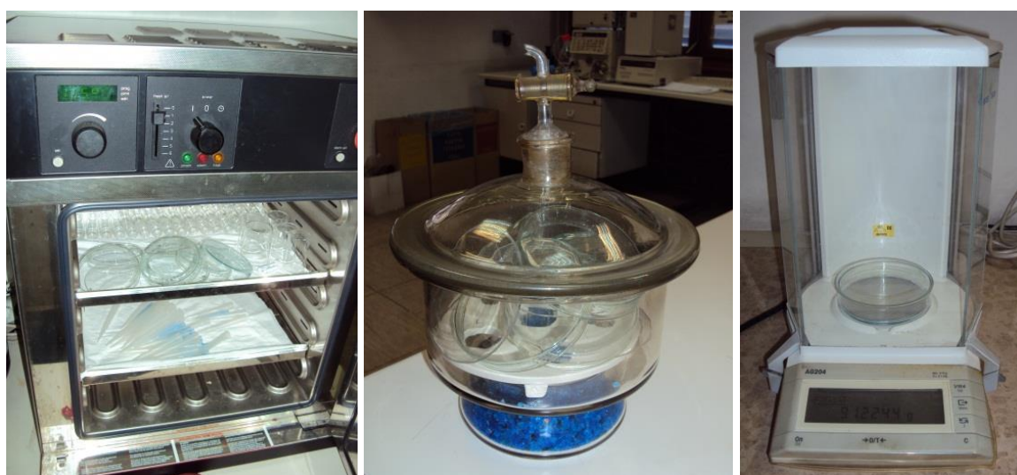
Slika 8. Sušenje stakla (lijevo), hlađenje u eksikatoru (sredina) i vaganje (desno)
