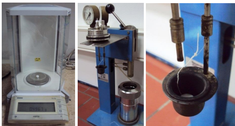
Slika 21. Vaganje benzojeve tablete (lijevo) i priprema za spaljivanje (sredina i desno)
