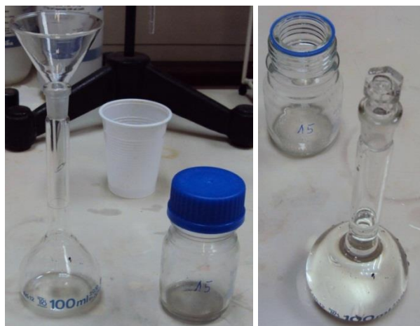
Slika 31. Razrjeđivanje kiseline na 100 ml demineraliziranom vodom
