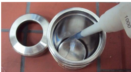
Slika 22. Dodavanje 1 ml demineralizirane vode u bombu (pipeta)
