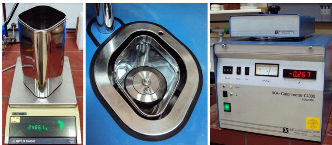
Slika 24. Priprema kalorimetrijske vode (lijevo), bomba unutar posude (sredina) i kalorimetar nakon zatvaranja poklopca (desno)
