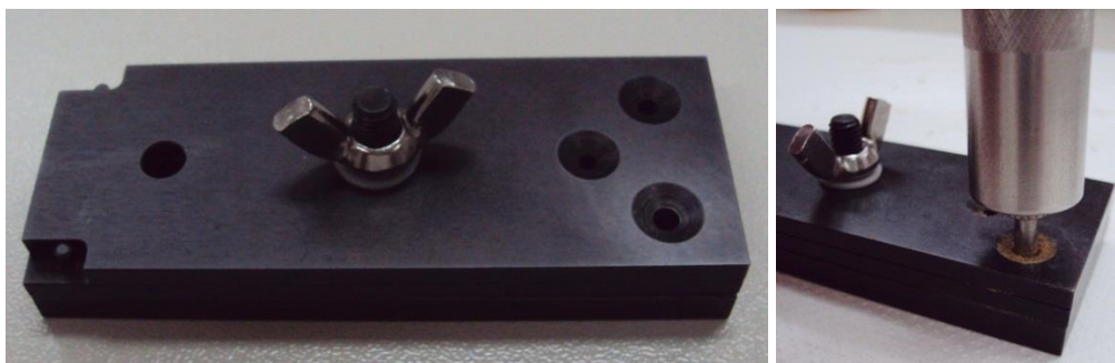
Slika 46. Kalup (lijevo) i izrada čunjića (desno)
