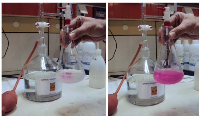
Slika 32. Titracija natrijevim hidroksidom (NaOH 0,1 N)
