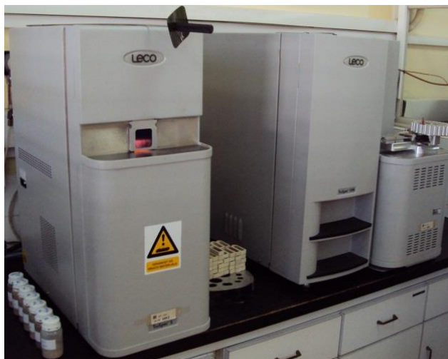
Slika 54. Analizator sumpora (lijevo) i analizator ugljika, vodika i dušika (desno)
