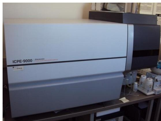
Slika 60. ICP emisijski spektrometar
