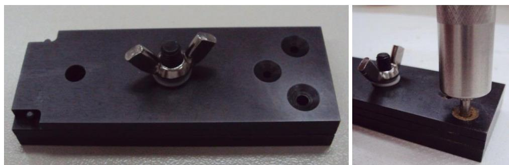
Slika 46. Kalup (lijevo) i izrada čunjića (desno)
