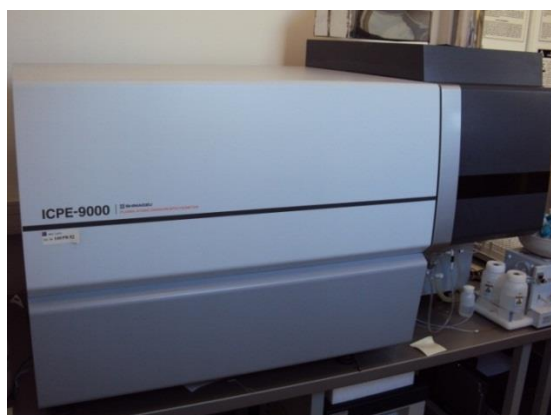
Slika 60. ICP emisijski spektrometar
