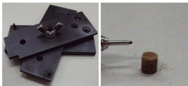
Slika 47. Otvoreni kalup (lijevo) i čunjić u usporedbi s vrhom tehničke olovke (desno)
