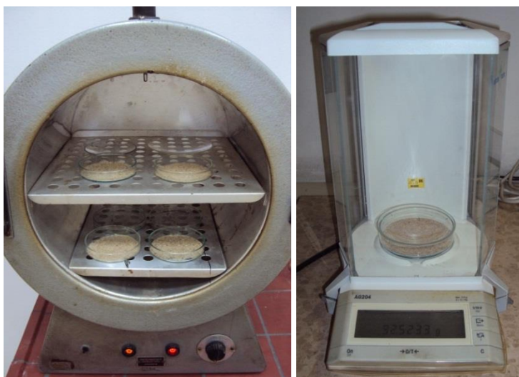
Slika 9. Sušenje uzoraka u sušioniku (lijevo) i vaganje osušenog uzorka (desno)
