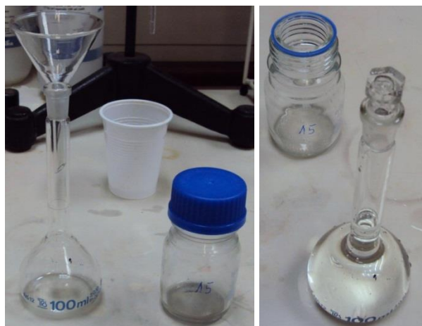
Slika 31. Razrjeđivanje kiseline na 100 ml demineraliziranom vodom
