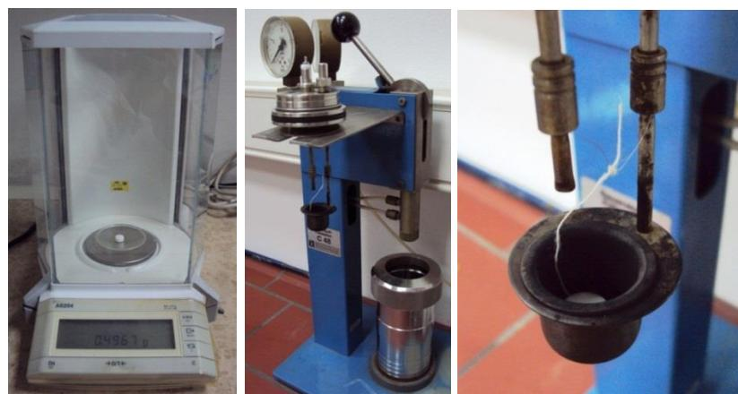
**Slika 21. Vaganje benzojeve tablete (lijevo) i priprema za spaljivanje (sredina i desno)**
