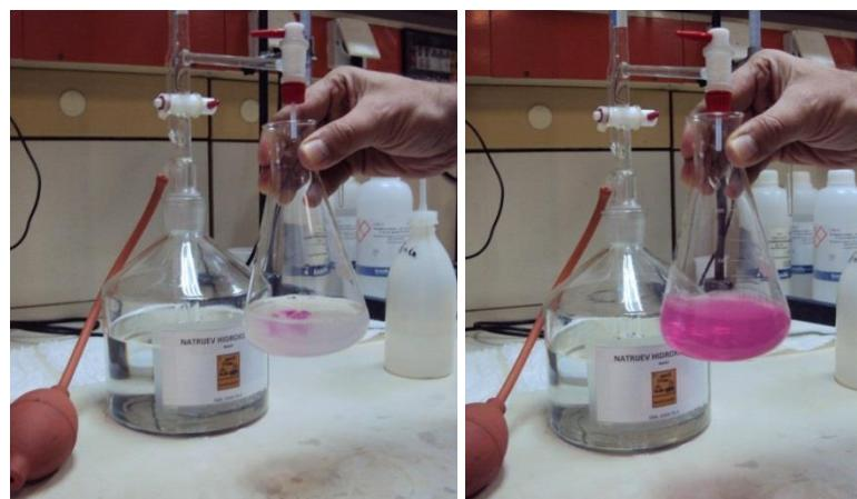
**Slika 32. Titracija natrijevim hidroksidom ( $\text{NaOH}$  0,1 N)**
