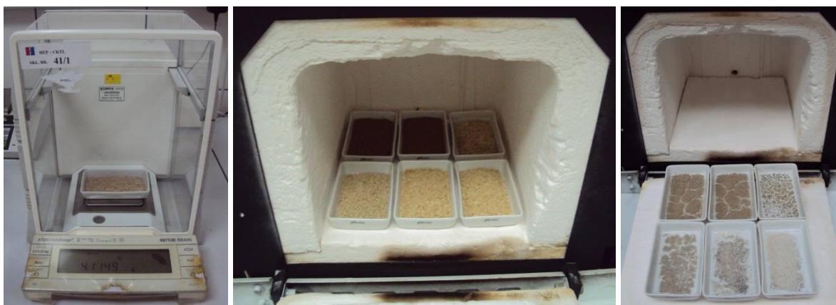
Slika 43. Vaganje uzorka (lijevo), uzorci prije (sredina) i nakon žarenja (desno)
