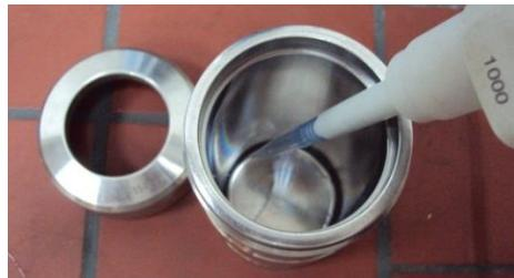
**Slika 22. Dodavanje 1 ml demineralizirane vode u bombu (pipeta)**
