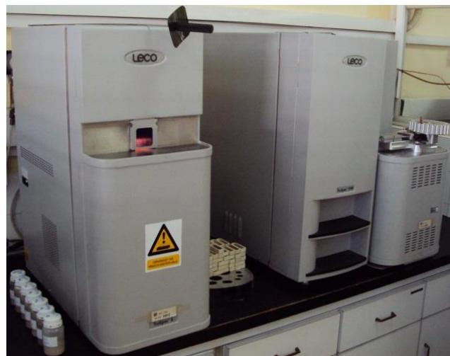
**Slika 54.** Analizator sumpora (lijevo) i analizator ugljika, vodika i dušika (desno)
