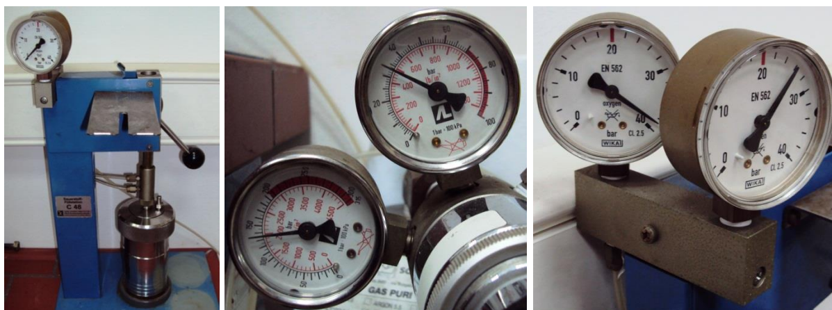
Slika 23. Punjenje kalorimetrijske bombe kisikom (lijevo), tlakovi na boci (sredina) i stanici za punjenje (desno)
