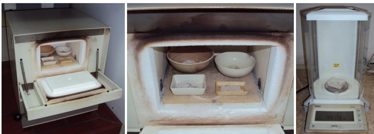
Slika 15. Uzorci sječke prije žarenja (lijevo), pepeo nakon žarenja (sredina) i vaganje pepela (desno)
