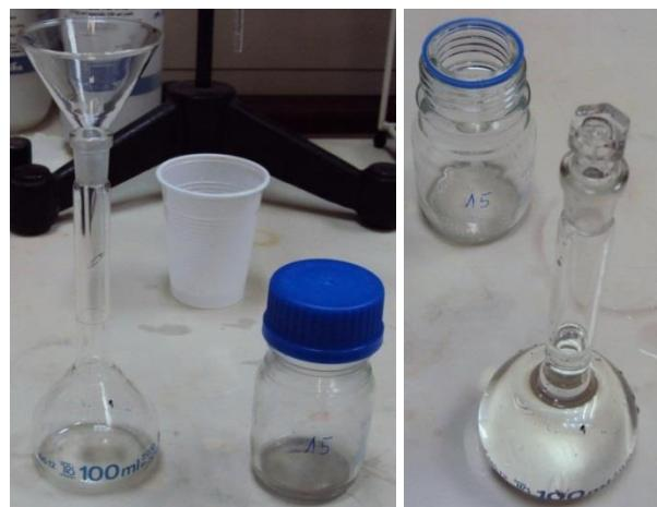
**Slika 31. Razrjeđivanje kiseline na 100 ml demineraliziranom vodom**
