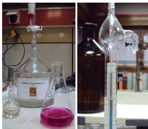
Slika 33. Završetak titracije (lijevo) i očitavanje utrošene lužine (desno)
