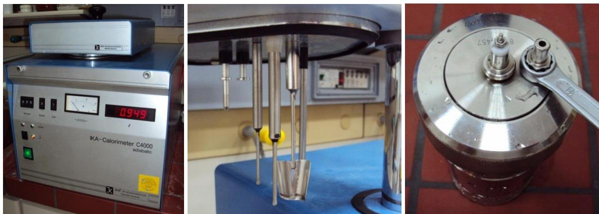
Slika 26. Kalorimetar tijekom izgaranja (lijevo), poklopac kalorimetra (sredina) i otpuštanje nepovratnog ventila (desno)
