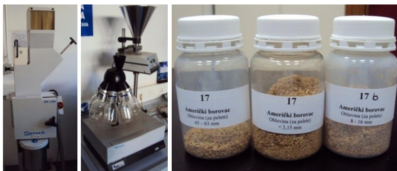
Slika 6. Mlin (lijevo) i rotacijski uzorkivač (sredina) (CKTL), granulirani uzorci (desno)
