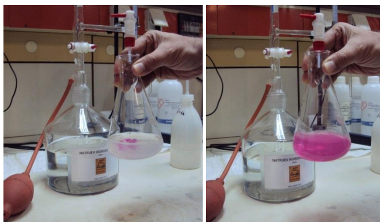
Slika 32. Titracija natrijevim hidroksidom (NaOH 0,1 N)
