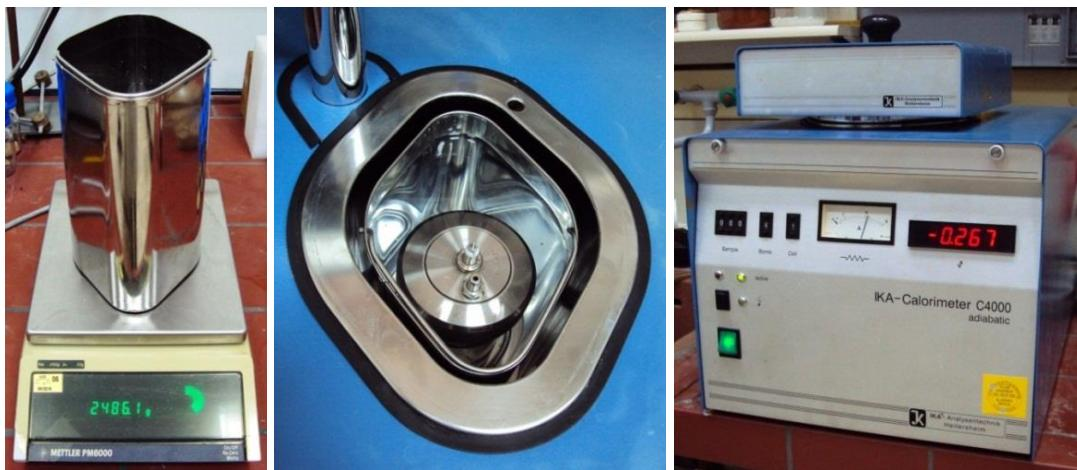
**Slika 24. Priprema kalorimetrijske vode (lijevo), bomba unutar posude (sredina) i kalorimetar nakon zatvaranja poklopca (desno)**
