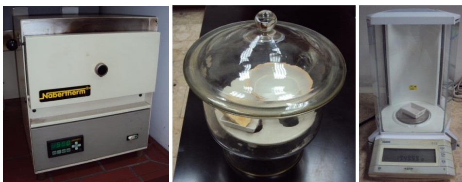
Slika 13. Žarenje lađice (lijevo), hlađenje u eksikatoru (sredina) i vaganje (desno)
