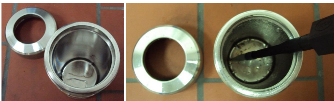
Slika 28. Unutrašnjost kalorimetrijske bombe prije (lijevo) i nakon izgaranja (desno)
