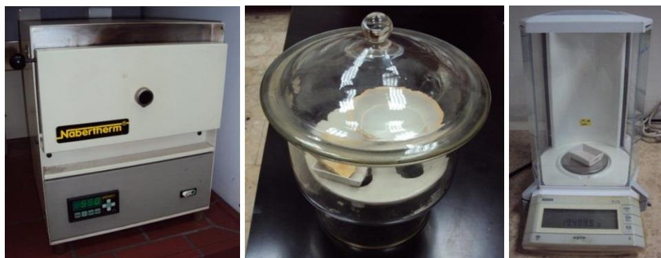
**Slika 13. Žarenje lađica (lijevo), hlađenje u eksikatoru (sredina) i vaganje (desno)**
