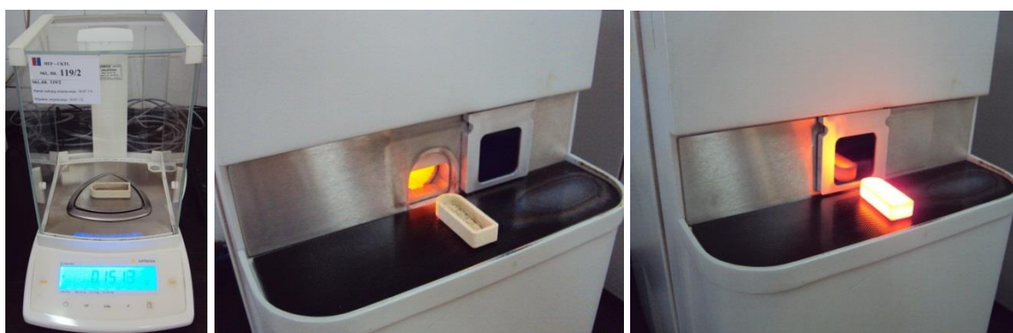
Slika 55. Vaganje lađice s uzorkom (lijevo), lađica s uzorkom prije (lijevo) i nakon (desno) analize sumpora
