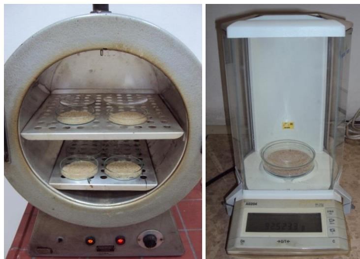
**Slika 9. Sušenje uzorka u sušioniku (lijevo) i vaganje osušenog uzorka (desno)**
