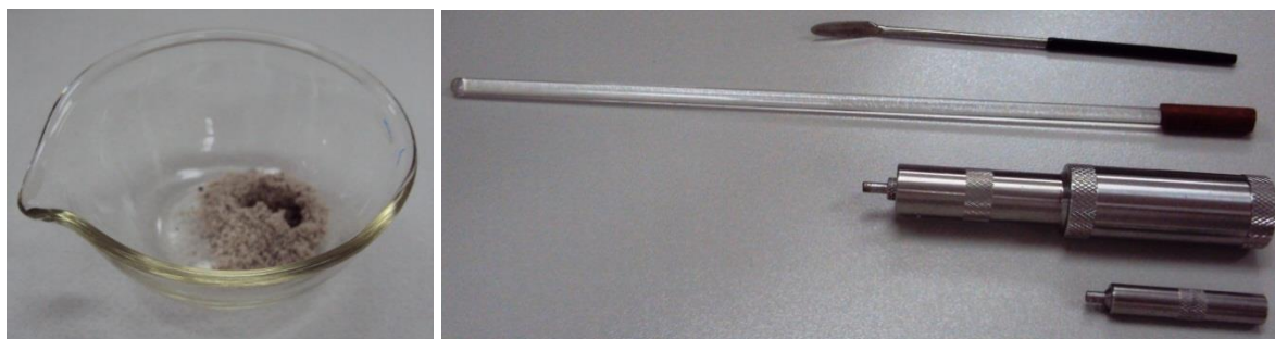
Slika 45. Priprema paste (lijevo) i pomagala pri izradi čunjića (desno)
