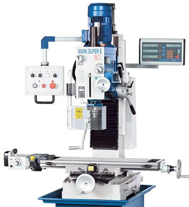
**Slika 24. Bušilica/glodalica – Mark Super S**
