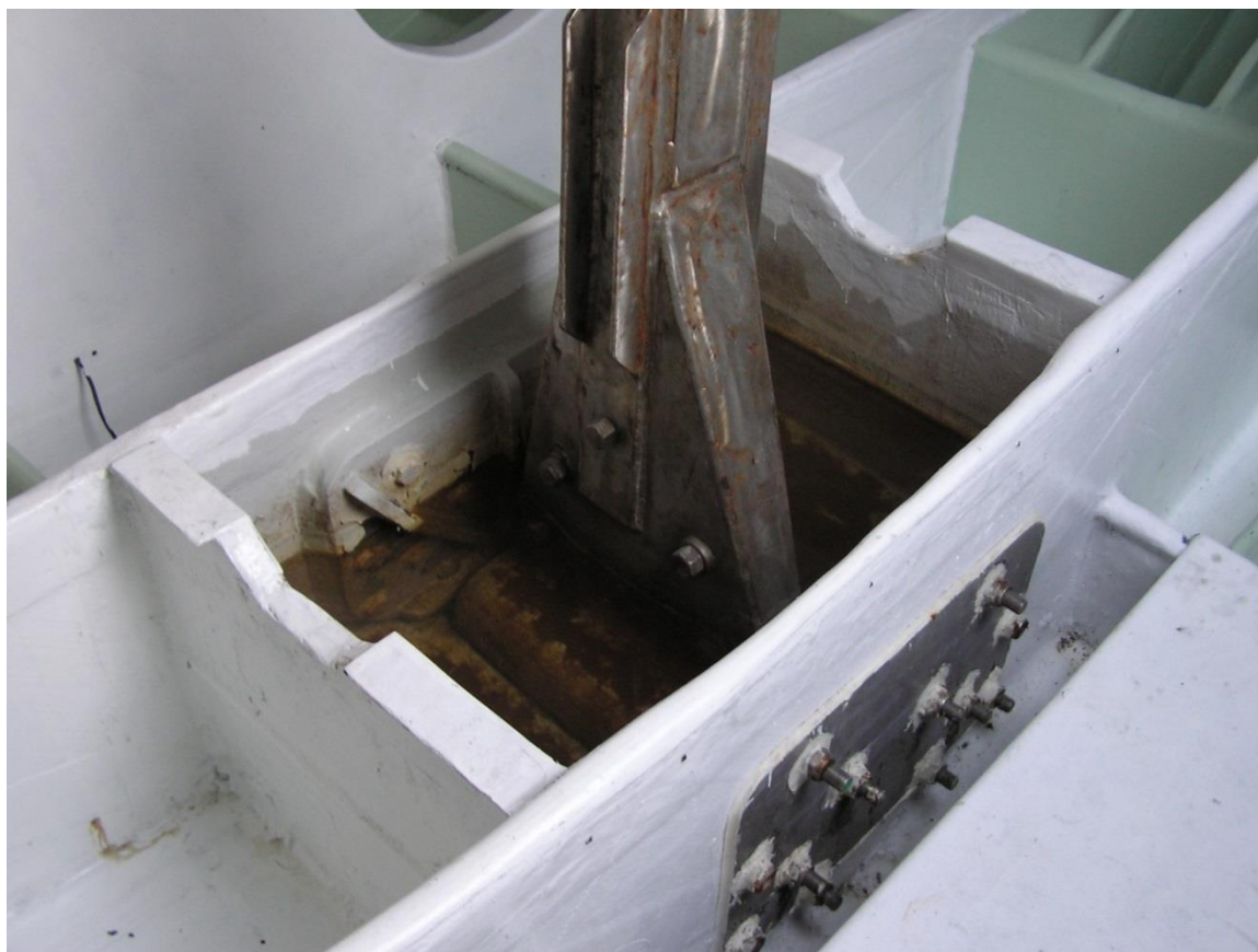
Slika 5. Osovina zakretne kobilice, brod Cometa
