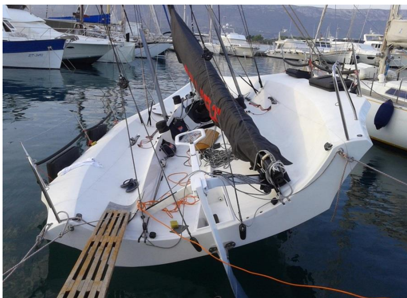
Slika 18. Brod Full Pelt nagnut pomoću zakretne kobilice
