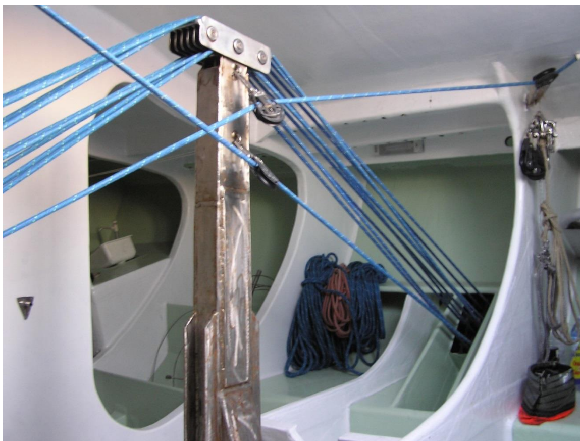
Slika 4. Sustav zakretanja kobilice konopima i užnicama, brod Cometa
