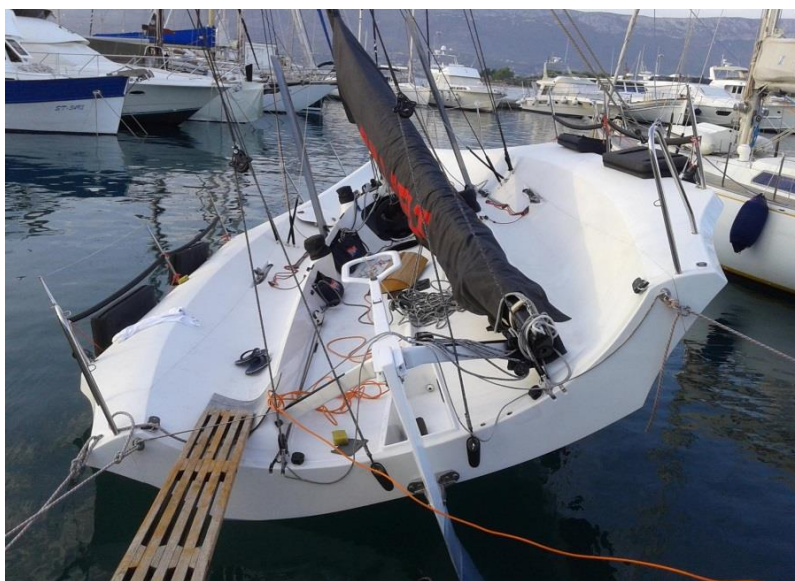
Slika 18. Brod Full Pelt nagnut pomoću zakretne kobilice
