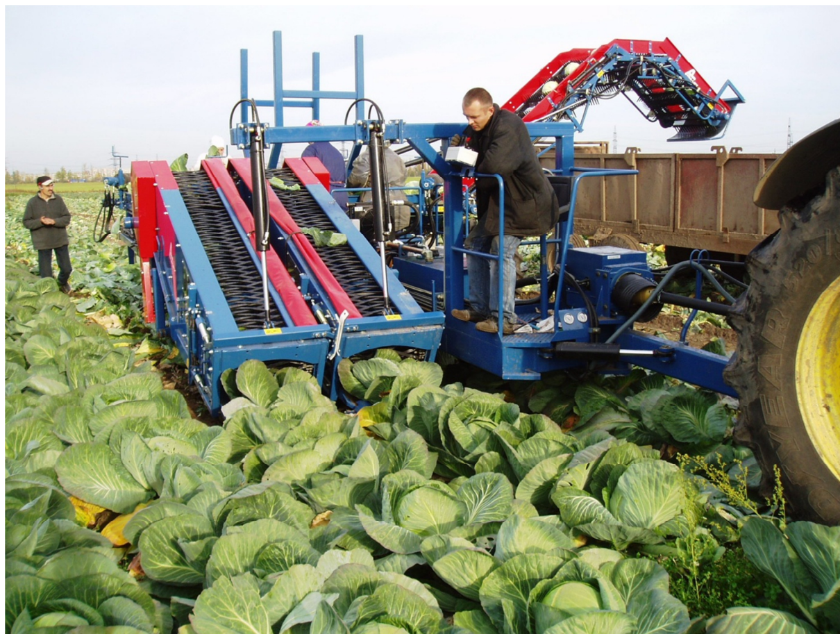
Slika 16. Dvoredni uređaj za branje kupusa
