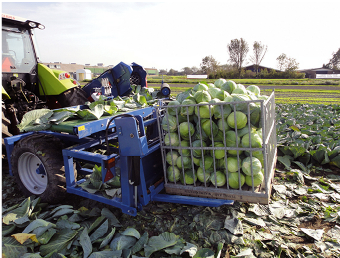
Slika 14. Prikaz prihvata sanduka za spremanje kupusa
