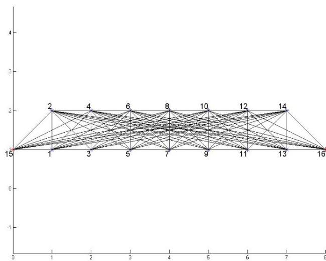
Slika 1.3. Inicijalna struktura (tzv. ground structure)
