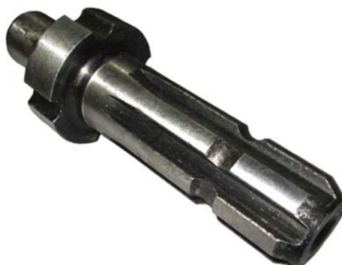
Slika 6. Izlazno vratilo sa 540 \text{ min}^{-1}
