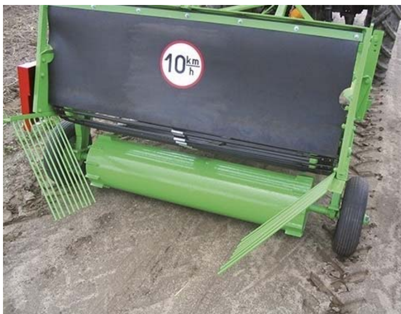
Slika 13. Valjak za poravnavanje zemlje
