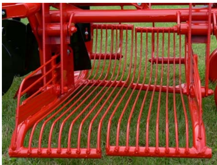
Slika 10. Rešetke koje se gibaju u suprotnim smjerovima
