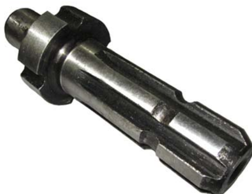
Slika 6. Izlazno vratilo sa 540 min -1
