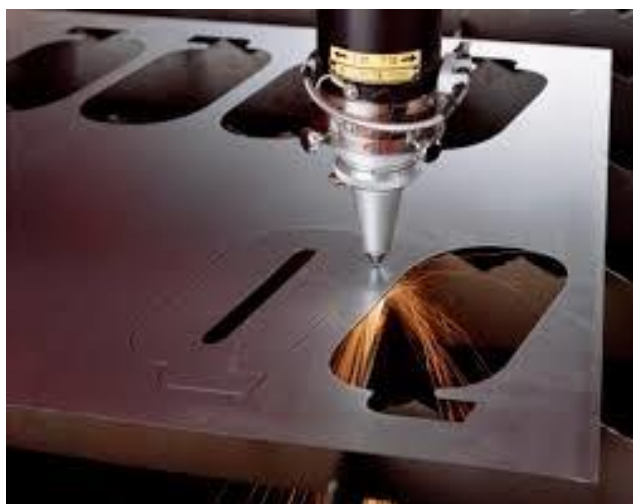
Slika 22. Lasersko rezanje CO 2 laserom [20]
