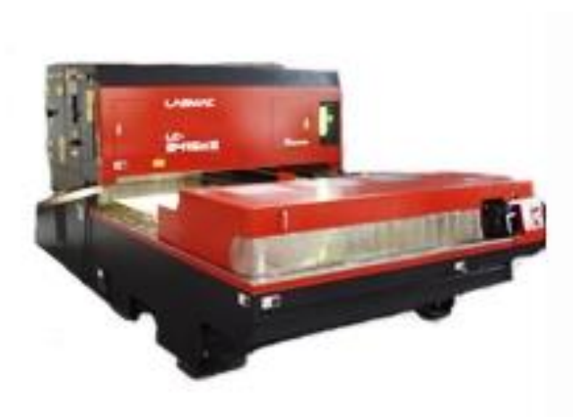
Slika 33. AMADA LASMAC – Laser za rezanje limova (2D) [27]
