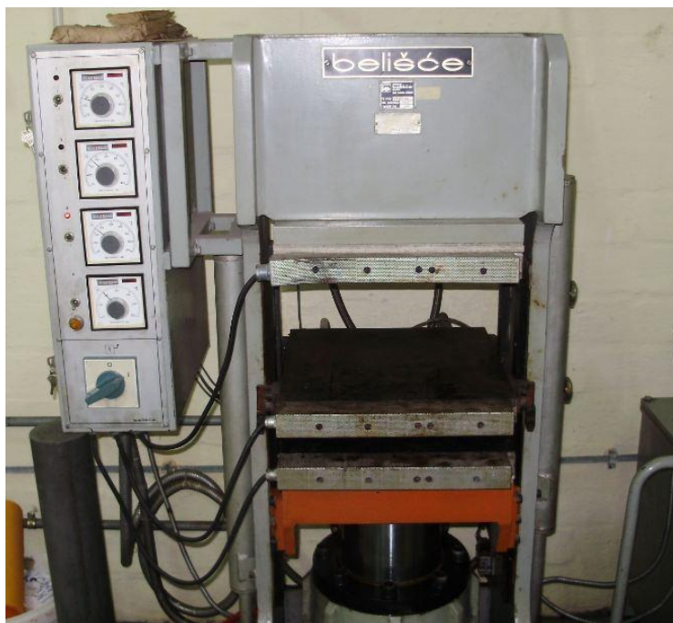
Slika 12. Preša PHPVEH 100 za prešanje ispitnih tijela na bazi polimera i kompozita [10]
