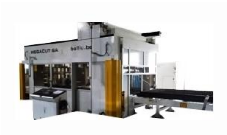
Slika 32. BALLIU MEGACUT 6A – Laser za rezanje i zavarivanje limova (2D i 3D) [27]
