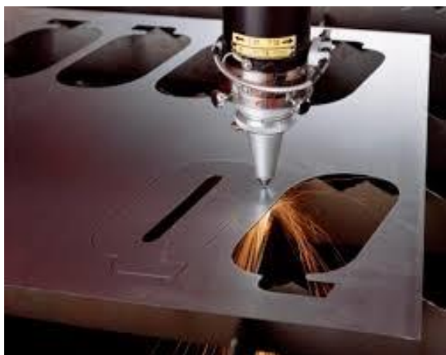
Slika 22. Lasersko rezanje CO 2 laserom [20]
