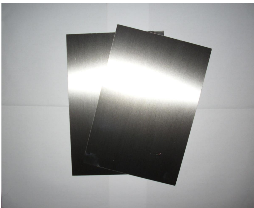
Slika 36. Ploče od nehrđajućeg čelika debljine 2 mm
