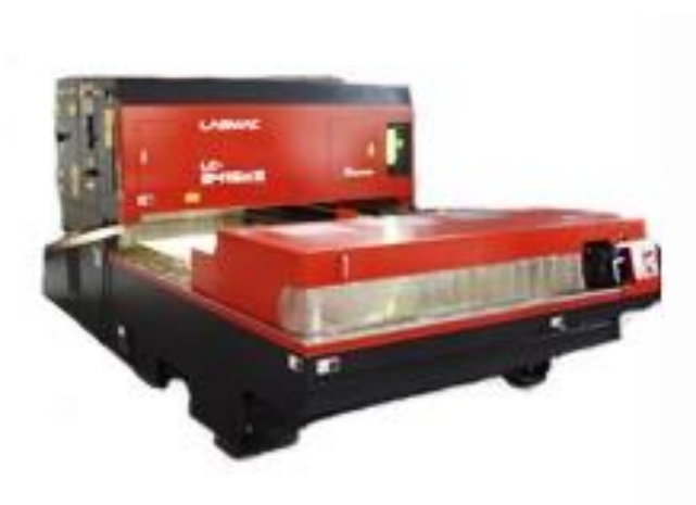
Slika 33. AMADA LASMAC – Laser za rezanje limova (2D) [27]
