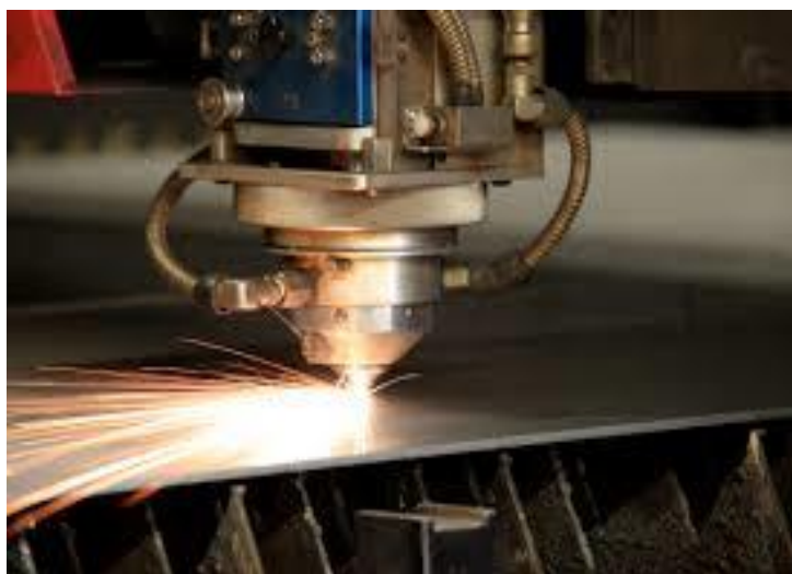
Slika 34. Prikaz rezanja limova AMADA LASMAC laserom [28]
