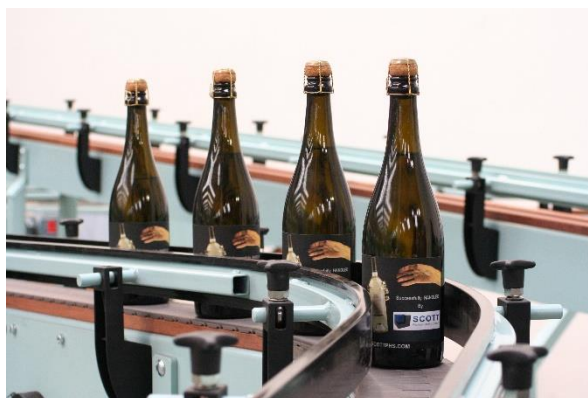
Slika 31. Konvejski lanac za boce
