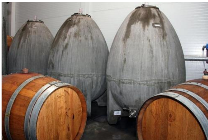
Slika 10. Betonske cisterne za vino
