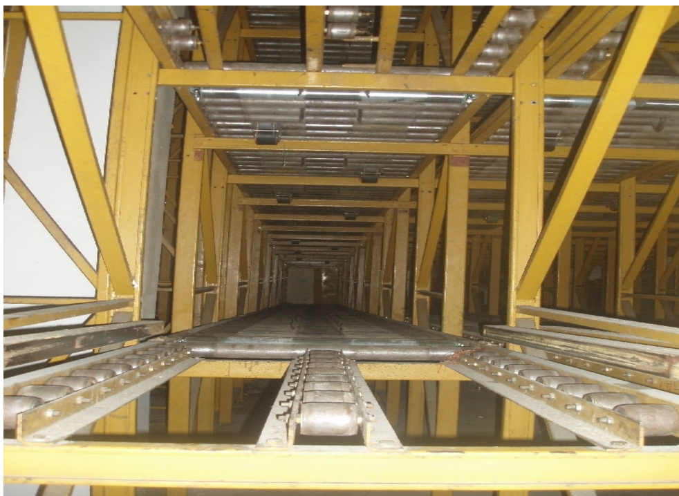
Slika 22. Tuneli valjčanih konvejera u skladištu
