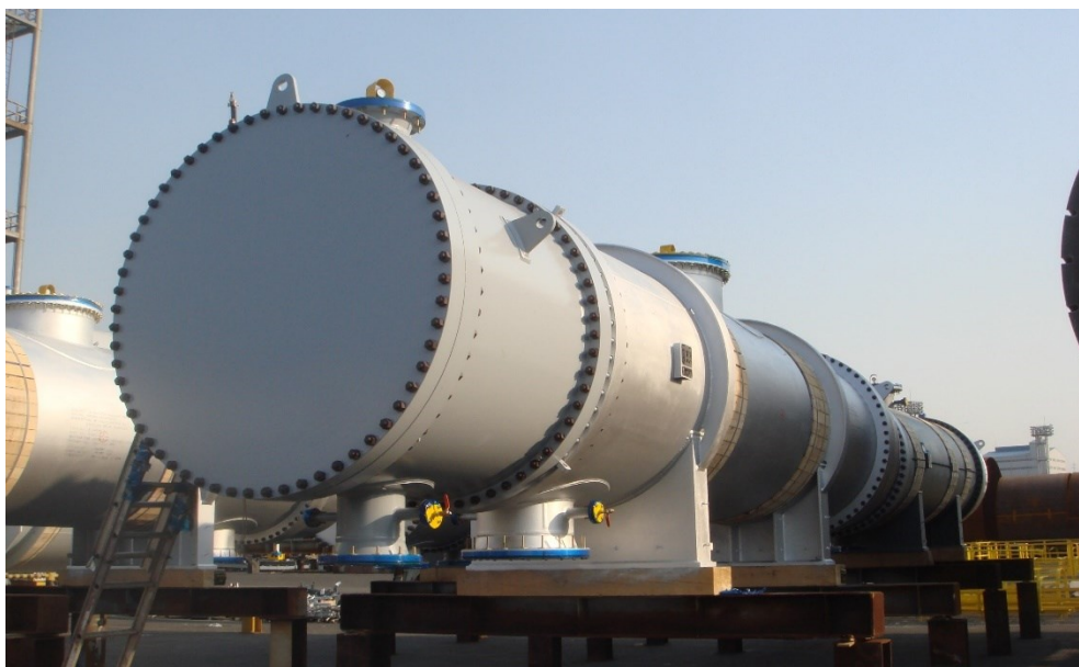
Slika 24. Prikaz tipičnog kondenzatora u termoelektrani [14]
