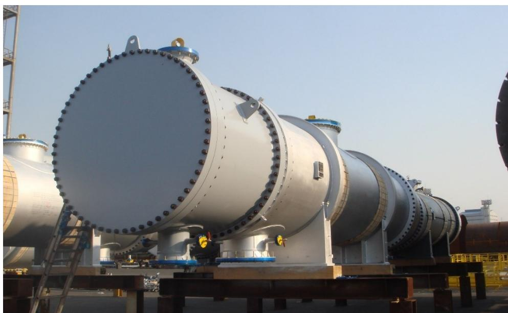
Slika 24. Prikaz tipičnog kondenzatora u termoelektrani [14]
