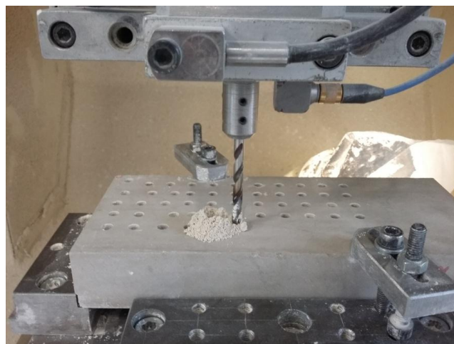
Slika 6.7. Ciklus mjerenja istrošenosti
