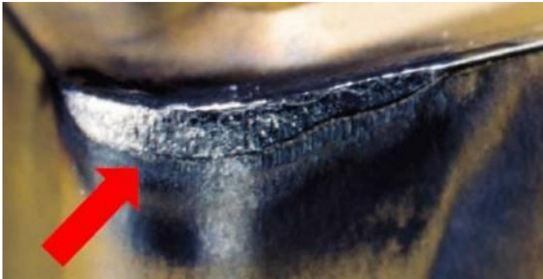
Slika 8. Trošenje stražnje površine alata [2]
