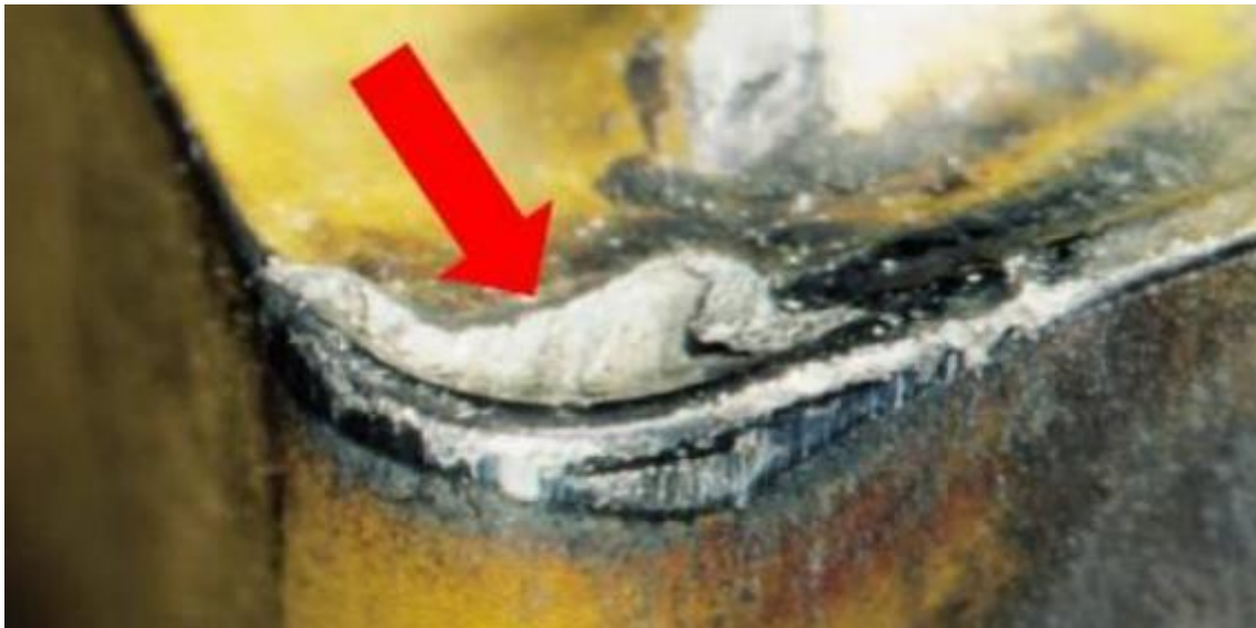
Slika 9. Kratersko trošenje alata [2]
