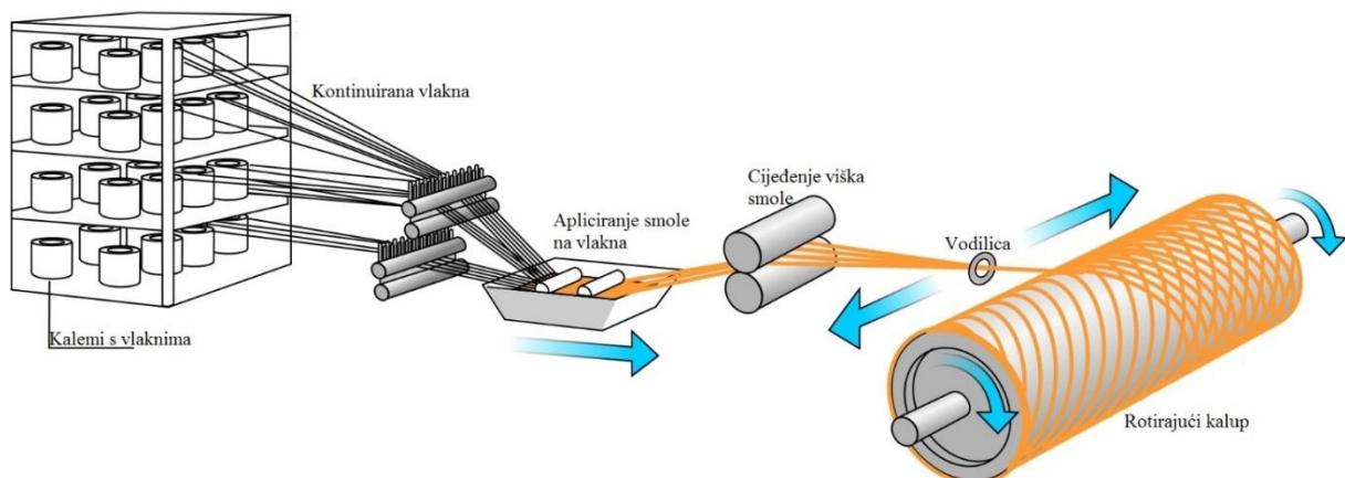
**Slika 11. Shematski prikaz proizvodnje cijevi od kompozitnog materijala**
