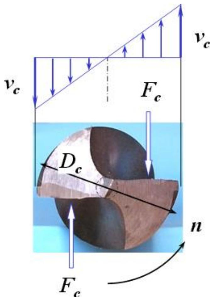
Slika 1. Profil glavnih brzina rezanja kod bušenja [1]
