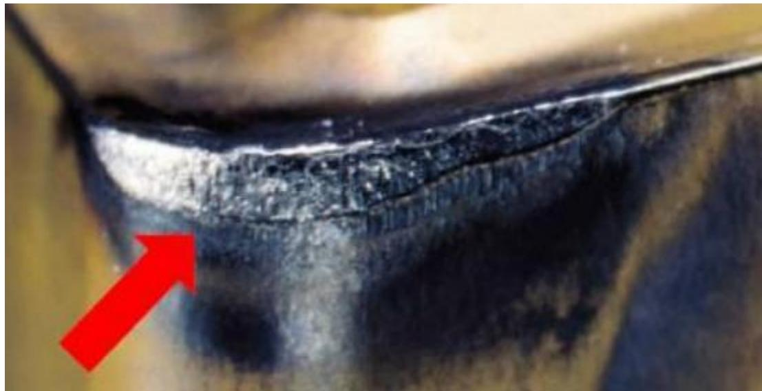
Slika 8. Trošenje stražnje površine alata [2]
