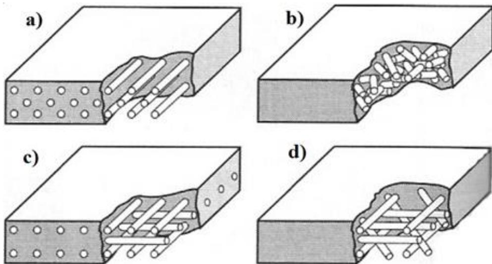
Slika 10. Raspored vlakana u vlaknima ojačanom kompozitu
