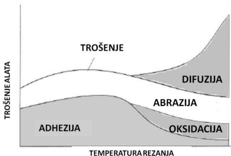
Slika 5. Trošenje alata u ovisnosti o temperaturi
