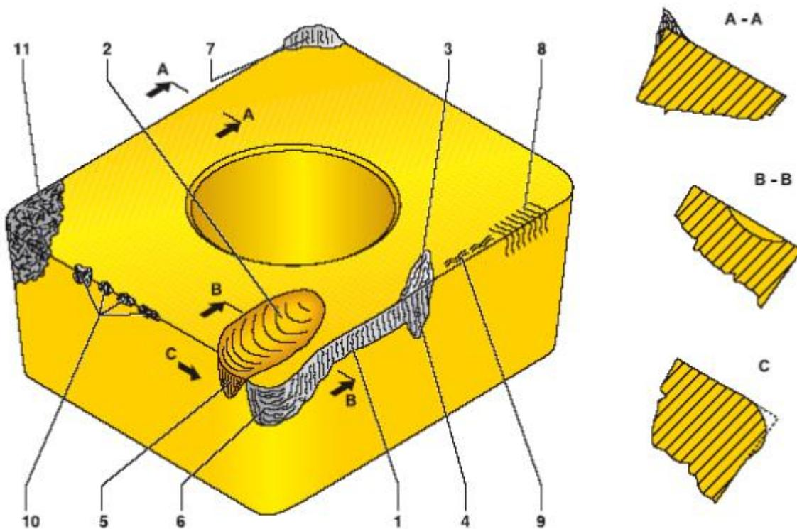
Slika 6. Mogući oblici trošenja reznih alata [5]
