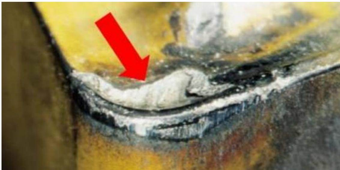
Slika 9. Kratersko trošenje alata [2]
