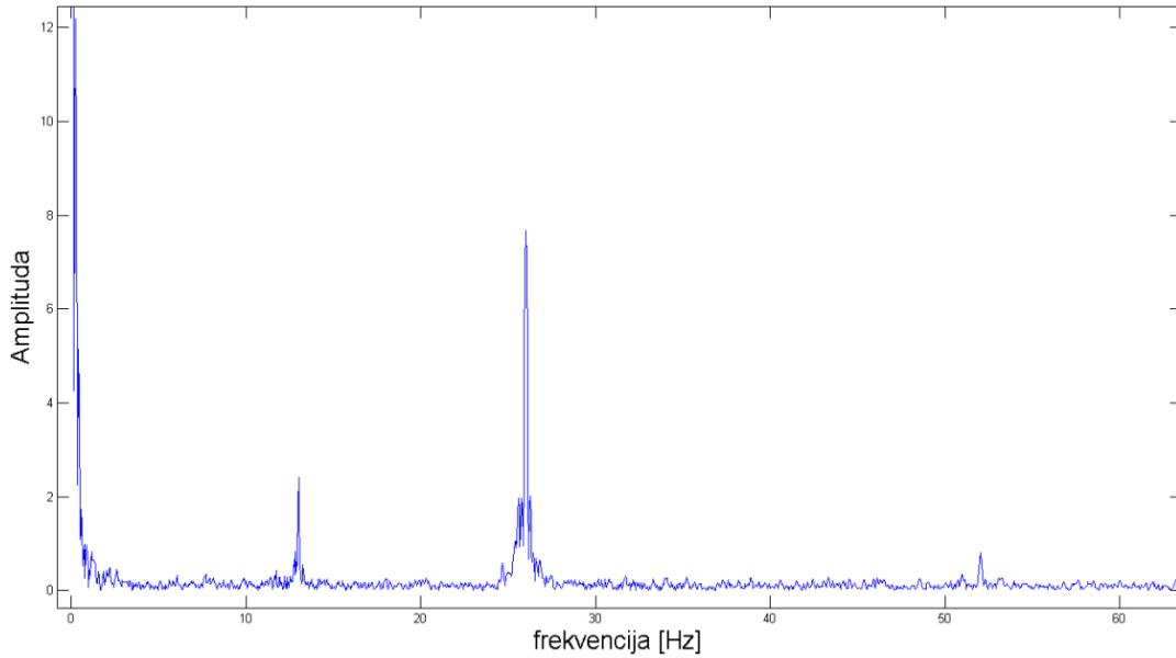
**Slika 25. Signal sile  $F_z$  u frekvencijskoj domeni**
