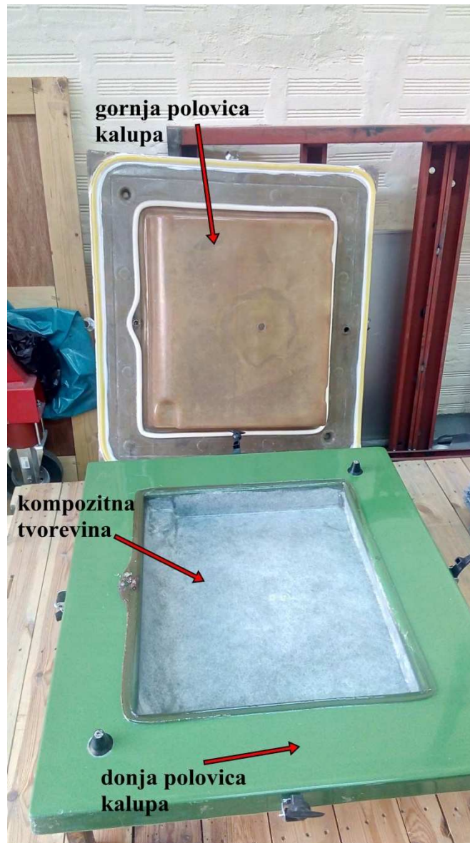
Slika 4.19. Kompozitna tvorevina u donjoj polovici kalupa prije vađenja
