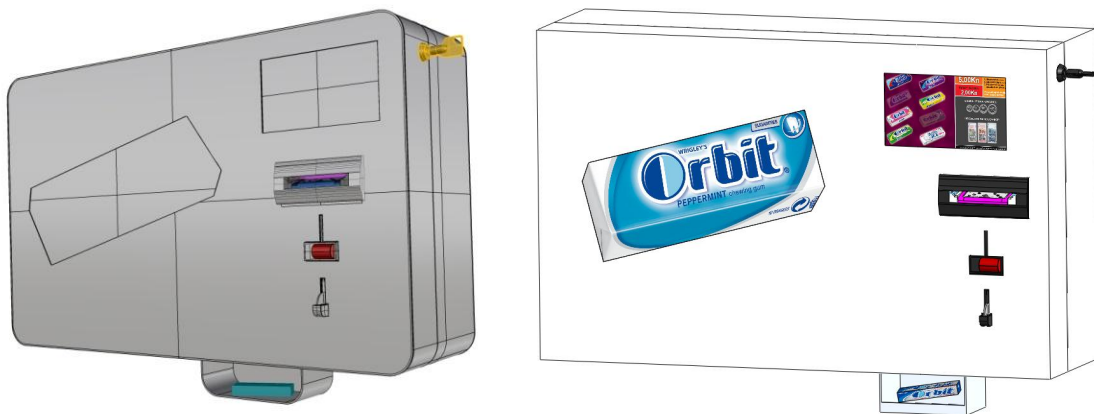
Slika 39. Samoposlužni aparat a) prvi dizajn b) redizajn
