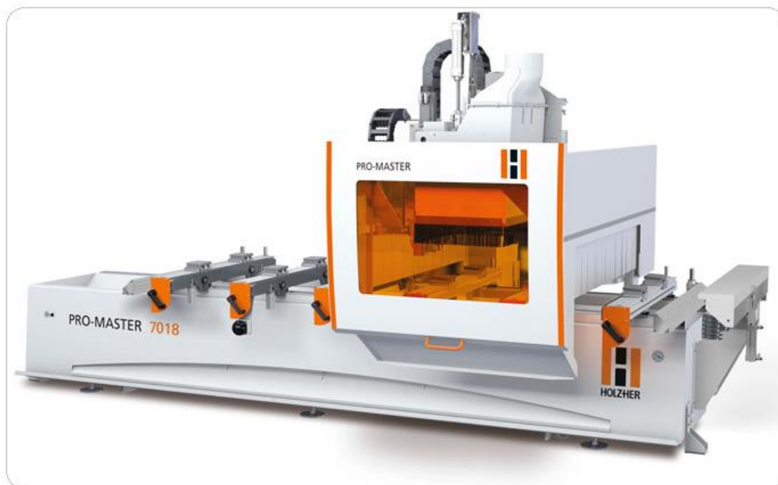
Slika 15. Obradni centar za obradu rubova [8]
