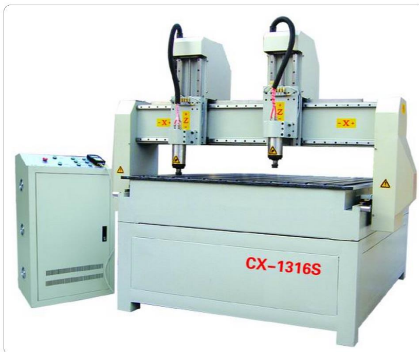
Slika 11. CNC stroj s dvije obradne glave [8]
