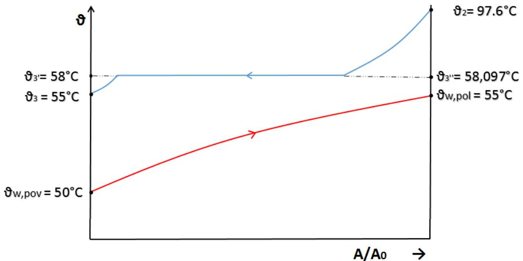
Slika 7. Temperature struja u kondenzatoru, 9-( $A/A_0$ ) dijagram
