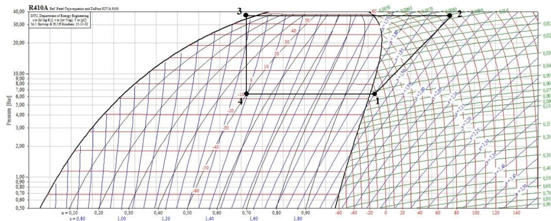
Slika 6. logp-h dijagram s karakterističnim radnim točkama procesa
