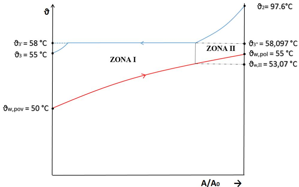
Slika 8. Dijagram 9-(A/A<sub>0</sub>) pločastog kondenzatora podjeljenog u zone
