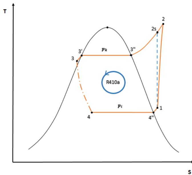
Slika 5. T-s dijagram s karakterističnim radnim točkama procesa
