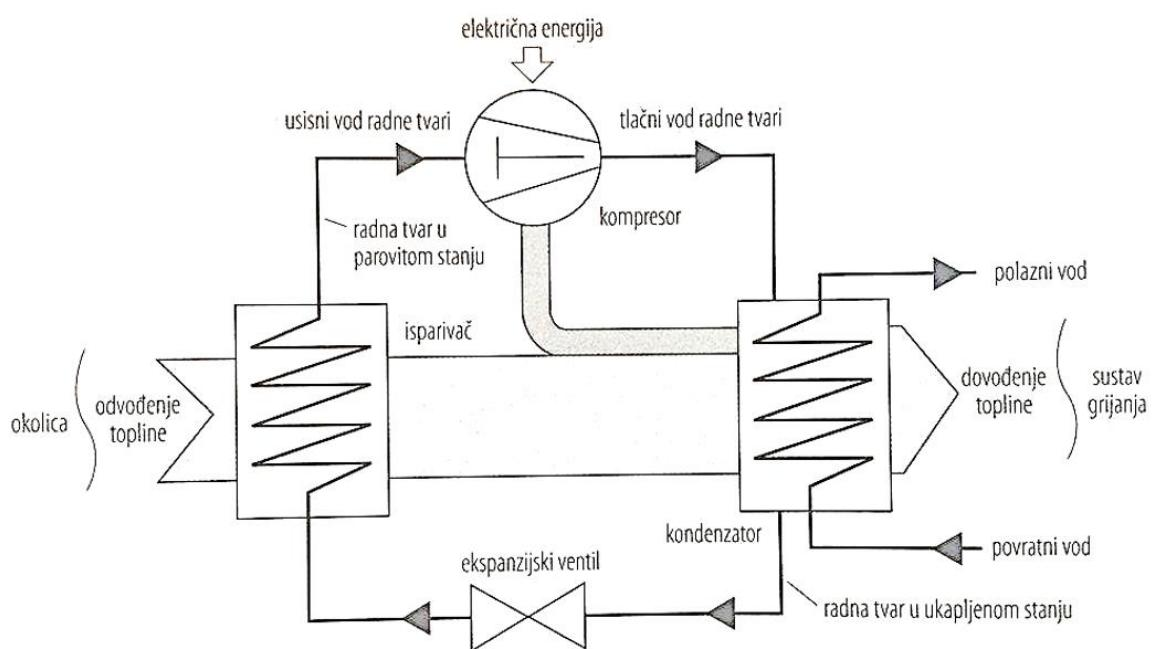
Slika 1. Shematski prikaz kompresorske dizalice topline [1]
