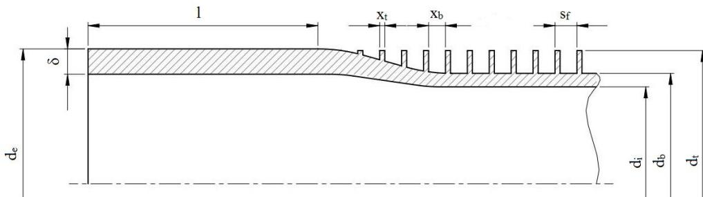
Slika 10. Presjek orebrene bakrene cijevi s karakteričnim dimenzijama
