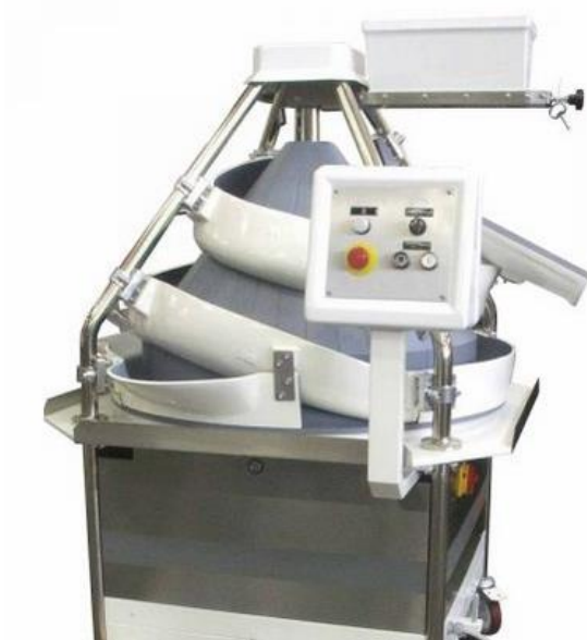
Slika 5 Stroj za okruglo oblikovanje [7]
