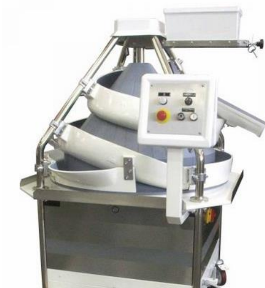
Slika 5 Stroj za okruglo oblikovanje [7]
