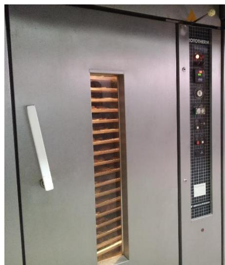
Slika 9 Peć za sušenje [2]
