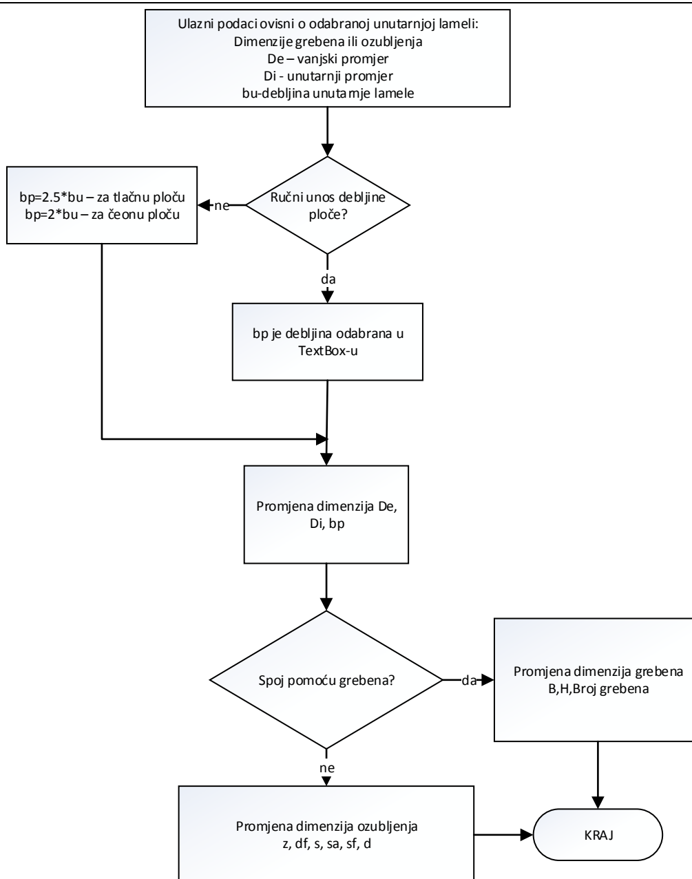
Slika 14. Dijagram toka procedure Ploca
