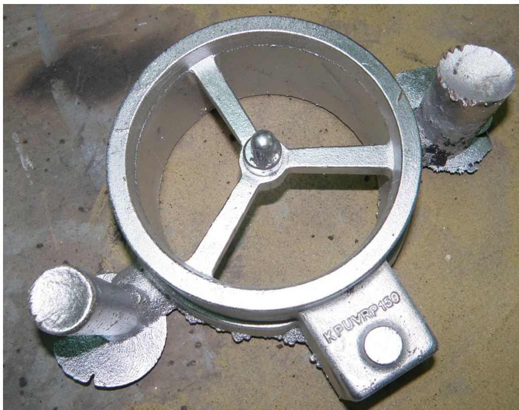
Slika 42. Potpuno očišćen odljevak
