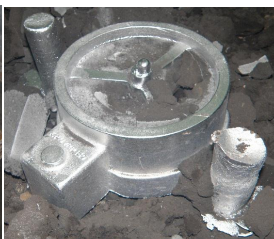
Slika 41. Djelomično očišćen odljevak
