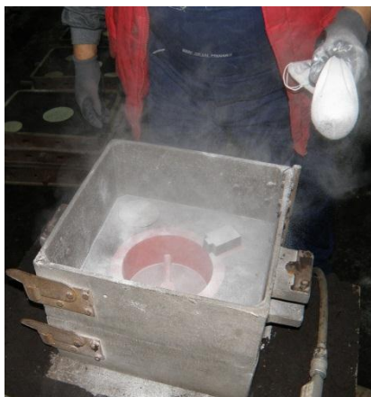
Slika 22. Posipavanje donjeg dijela modela
