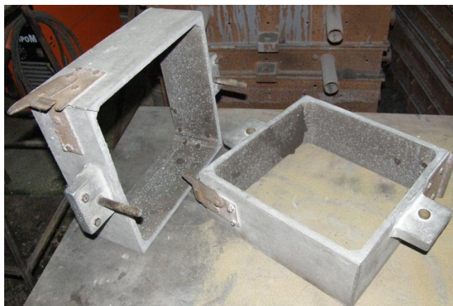
Slika 15. Dijelovi kalupnika: lijevo gornji dio, desno donji dio
