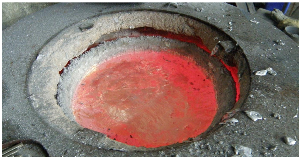
Slika 36. Talina spremna za lijevanje
