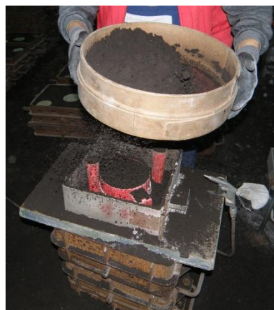
Slika 17. Prosijavanje prvog sloja pijeska
