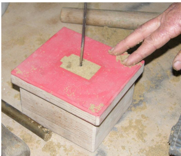
Slika 8. Pravljenje šupljine za propuhivanje
