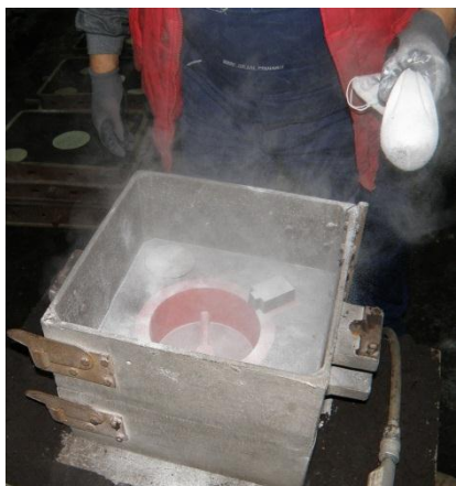
Slika 22. Posipavanje donjeg dijela modela
