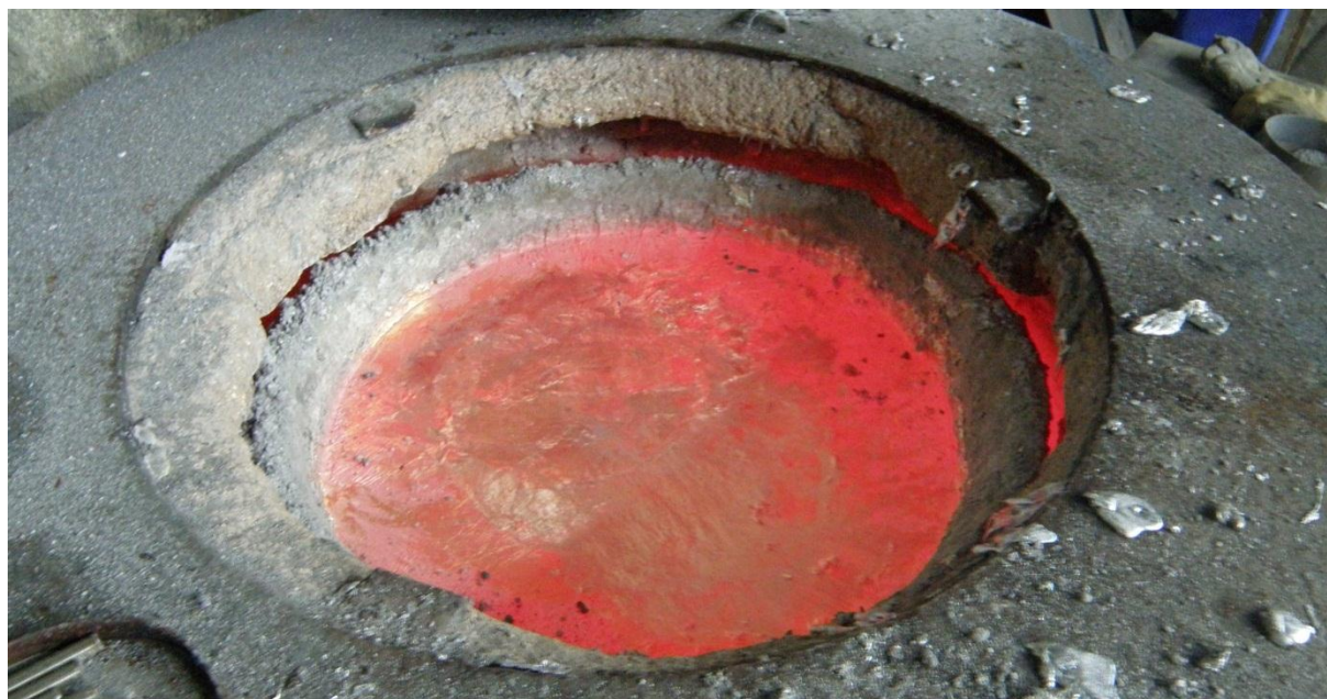
Slika 36. Talina spremna za lijevanje
