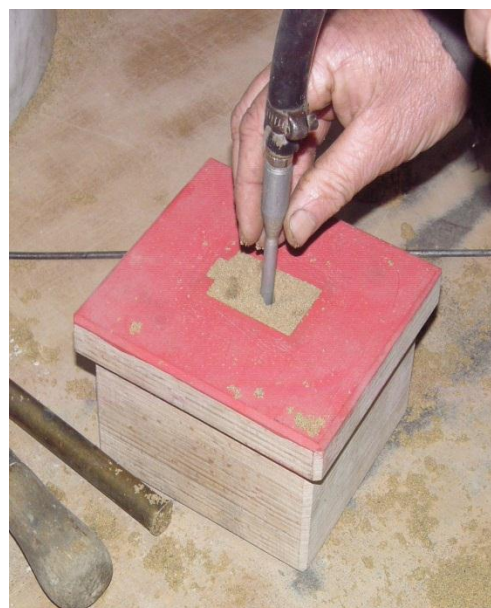
Slika 9. Propuhivanje plinom CO 2
