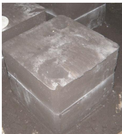
Slika 30. Gotov kalup (sklopljeni gornji i donji dio)
