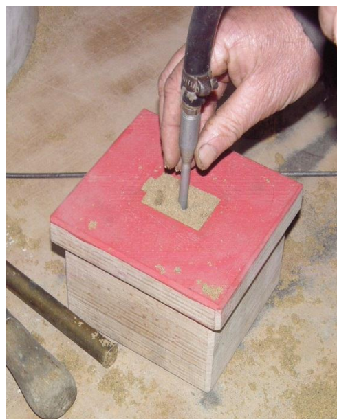
Slika 9. Propuhivanje plinom CO 2
