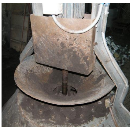
Slika 45. Ulazni otvor razrahljivača
