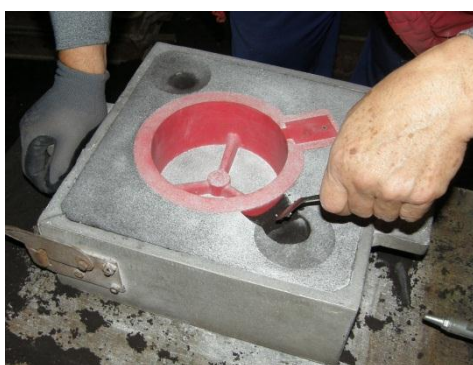
Slika 26. Pravljenje kanala za talinu
