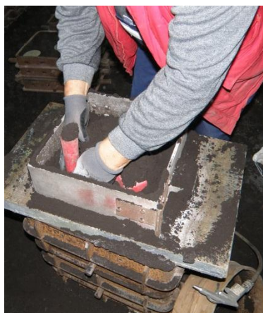
Slika 18. Ručno utiskivanje prvog sloja mješavine
