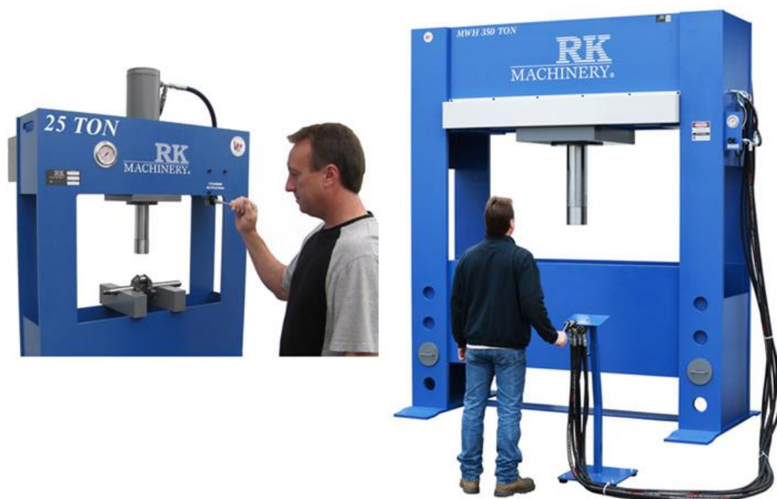
Slika 4. RK Machinery, H – oblik preša od 25 (lijevo) i 30 t (desno)
