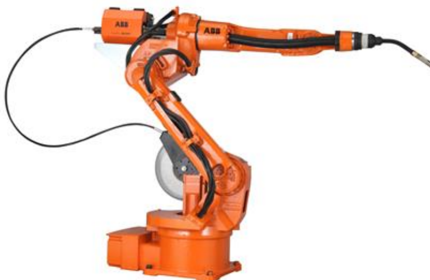
Slika 13. Robotska ruka ABB IRB 1520 ID
