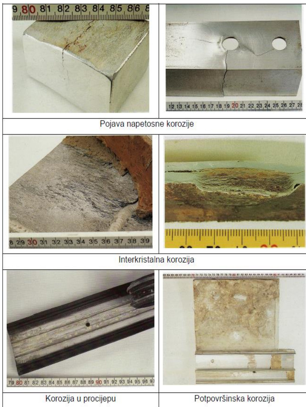
Slika 13. Pojavni oblici korozije na aluminiju i njegovim legurama [11]
