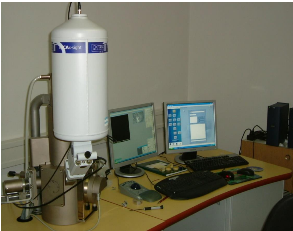
Slika 36. Elektronski mikroskop Tescan i EDX analizator
