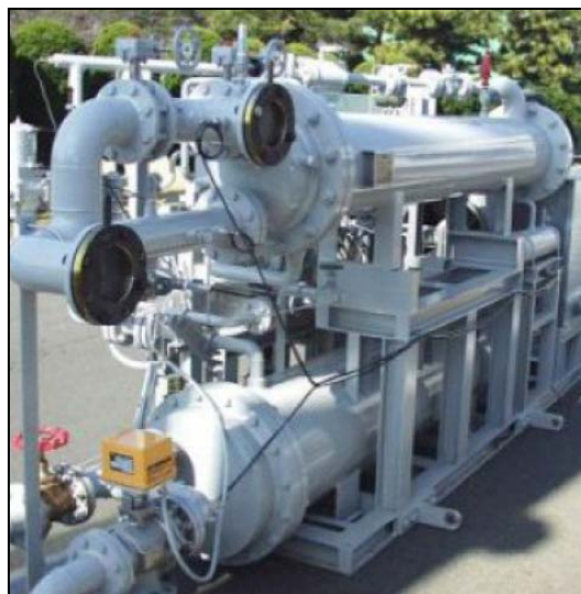
Slika 7.3 Mayekawa ejektorski rashladni uređaj pogonjen s MSUI [2]
