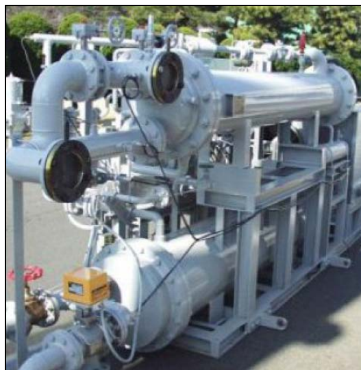
Slika 7.3 Mayekawa ejektorski rashladni uređaj pogonjen s MSUI [2]
