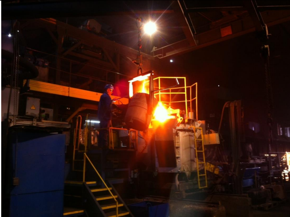
Slika 55. Lijevanje na DISAMATIC® liniji
