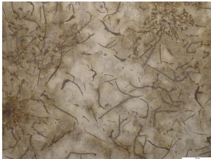
Slika 70. Metalografska snimka mikrostrukture sivog lijeva u nagrizenom stanju, 500x
