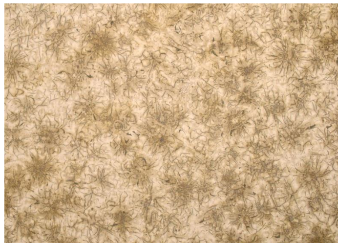
Slika 68. Metalografska snimka mikrostrukture sivog lijeva u nagrizenom stanju, 100x
