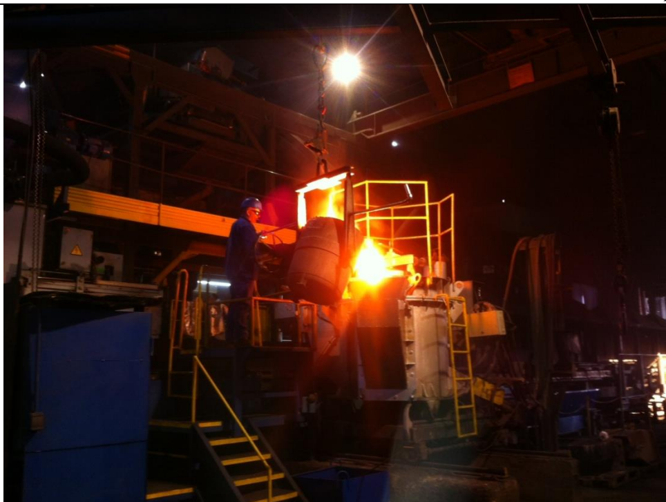
Slika 55. Lijevanje na DISAMATIC® liniji
