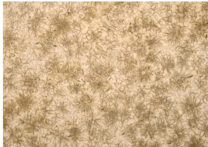
Slika 68. Metalografska snimka mikrostrukture sivog lijeva u nagrzenom stanju, 100x
