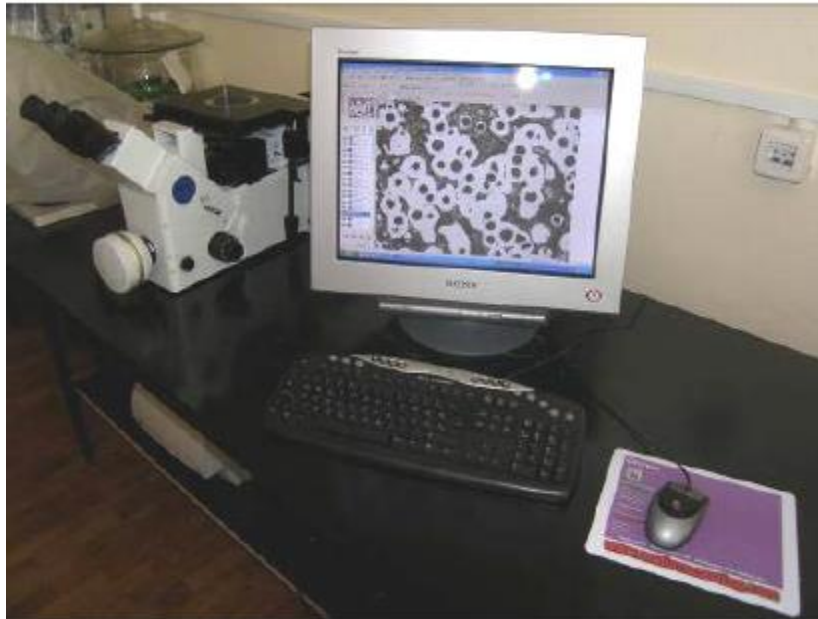
Slika 56. Svjetlosni mikroskop s digitalnom kamerom (Olympus GX 51)
