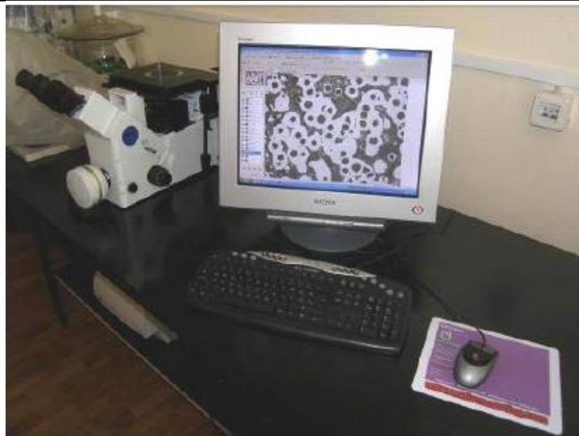
**Slika 56. Svjetlosni mikroskop s digitalnom kamerom (Olympus GX 51)**
