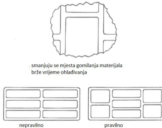
Slika 31. Pravilno konstruiranje sekcija [11]
