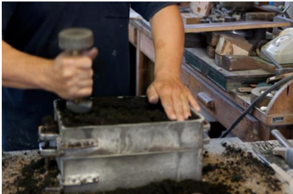
Slika 58. Sabijanje kalupne mješavine
