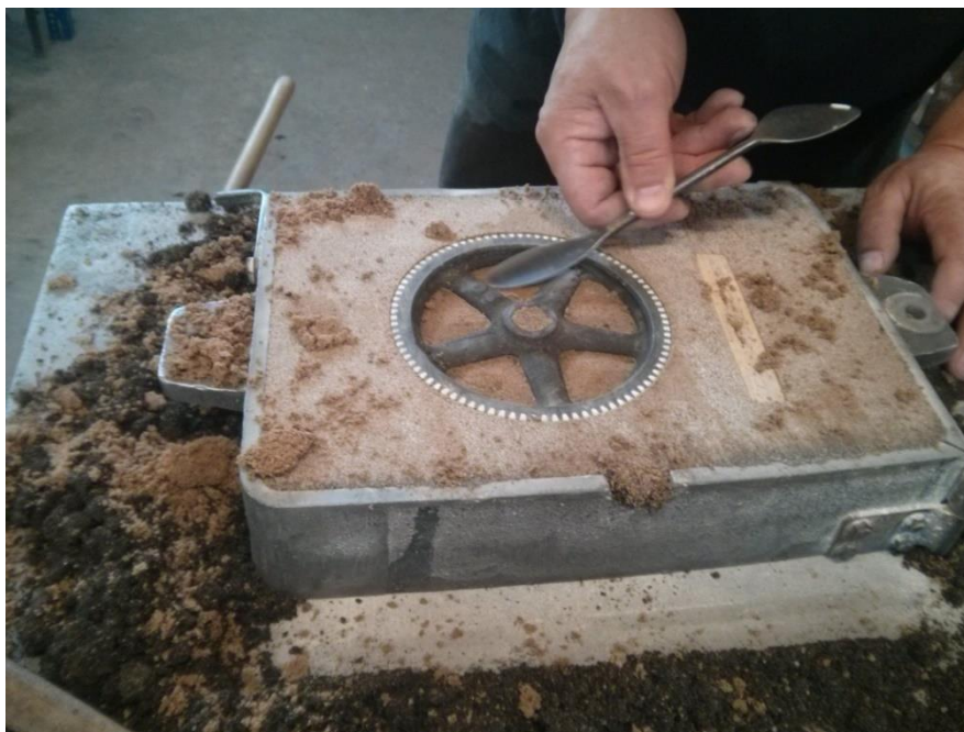
Slika 60. Prikaz modela zupčanika i lančanika unutar kalupa i čišćenje viška pijeska lancetom
