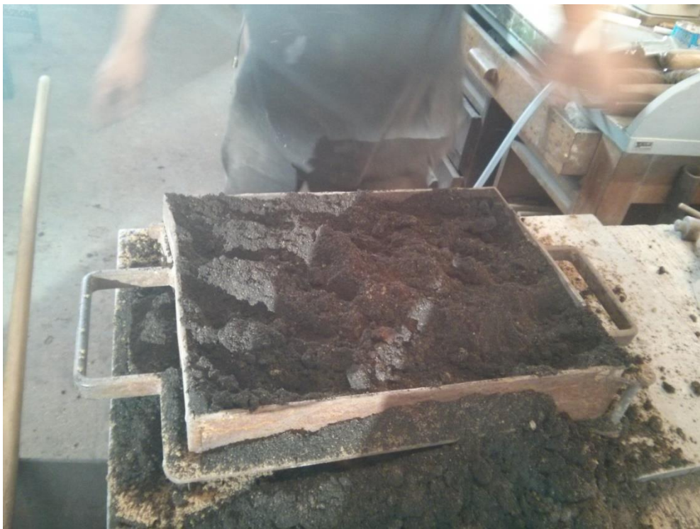
Slika 57. Nasipavanje dopunskim pijeskom
