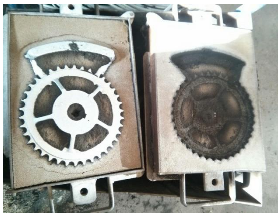
Slika 71. Otvaranje i rastresanje kalupa
