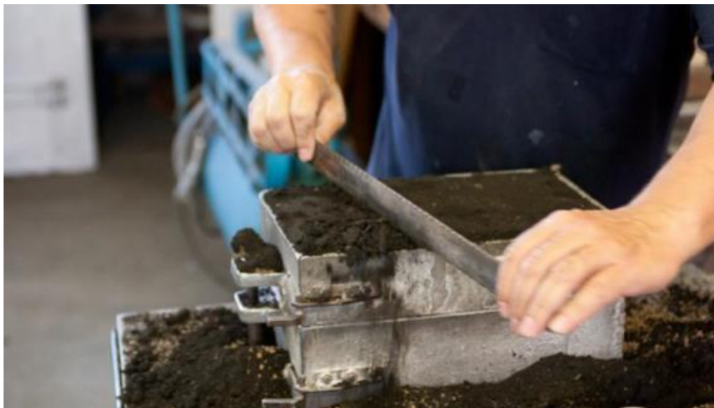
Slika 59. Poravnavanje donjeg dijela površine kalupa
