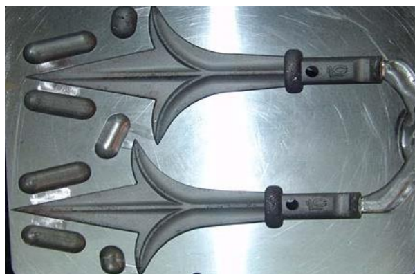
Slika 6. Prikaz stalnog kalupa za lijevanje dijelova umjetničkih ograda [4]
